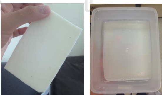
รูปที่ 4.6 ลักษณะทางกายภาพของเซลลูโลสแอโรเจลแห้ง (ก) แอโรเจลเปียก (ข)
