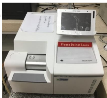
รูปที่ 3.6 เครื่องวิเคราะห์น้ำหนักภายใต้ความร้อน (TGA)
