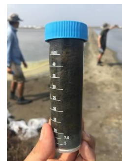
ค. การเก็บตัวอย่างดินเพื่อวิเคราะห์ปริมาณซัลไฟด์ทั้งหมด
