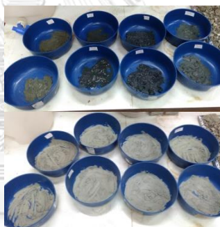
ข. สภาพของดินสด (บน) และแห้ง (ล่าง) เพื่อใช้วิเคราะห์ปริมาณสารอินทรีย์ในดิน
