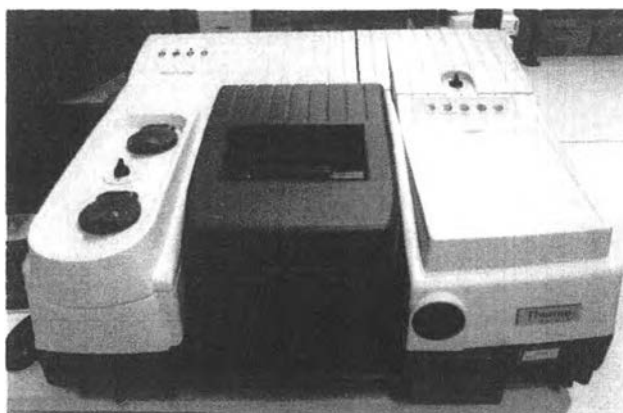
รูปที่ 3.4 เครื่อง FT-IR ของ Thermo Fisher Scientific รุ่น Nicolet 6700
