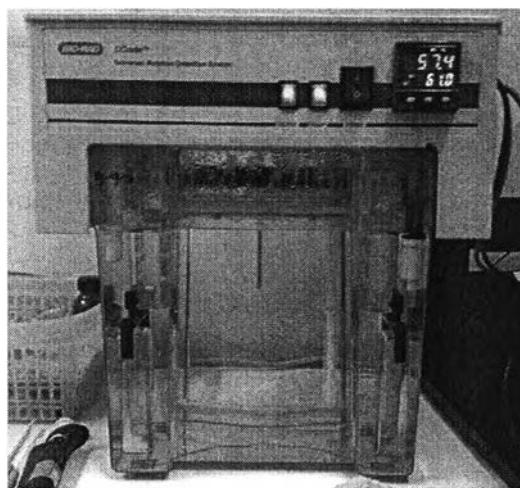
ภาพที่ ค.6 แสดงการประกอบเครื่อง Dcode™ ที่พร้อมใช้งาน
