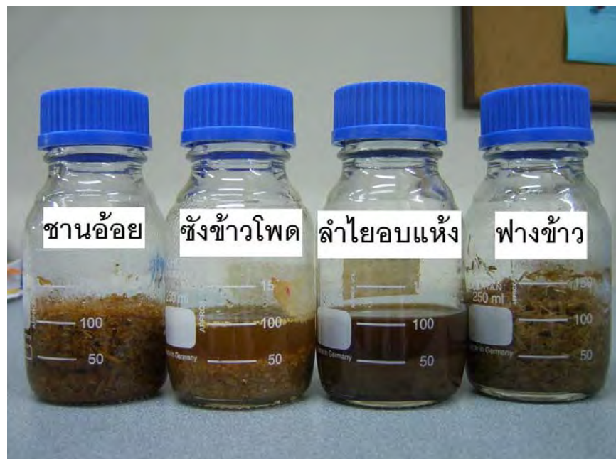
รูปที่ 4.7 ลักษณะของวัสดุเหลือใช้ทางการเกษตรชนิดต่างๆ (10 กรัม%โดยปริมาตร) ในกรดซัลฟูริกเข้มข้น 0.75 %โดยน้ำหนัก/ปริมาตร (ก) ก่อนการปรับสภาพ และ (ข) หลังการปรับสภาพ ที่ 121 องศาเซลเซียส ในหม้อนึ่งความดันไอน้ำ 15 ปอนด์/ตารางนิ้ว 60 นาที
