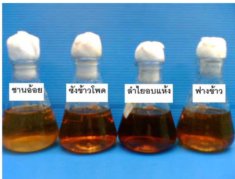
รูปที่ 4.30 ลักษณะสีของสารละลายน้ำตาลรีดิวซ์ที่ได้จากการย่อยสลายด้วยเซลลูเลส
