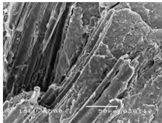
รูปที่ 4.4ค แสดงภาพการกระจายตัวของผงไม้ ขนาด 250μm,1.0%, 20 phr(treated)
