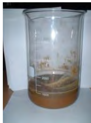
รูปที่ 3.5 การเคลือบวัสดุเสริมด้วยสาร ประสาน
