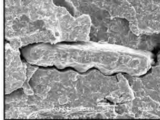
รูปที่ 4.4ค แสดงภาพการยึดติดระหว่างเฟสของแกลบ ขนาด 250μm, 20 phr(Untreated)
