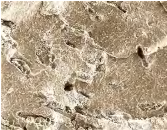
รูปที่ 4.4ข แสดงภาพการยึดติดระหว่างเฟสของแกลบ ขนาด 250μm, 0.2%, 20 phr(treated)
