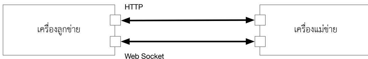
ภาพที่ 4.3 สถาปัตยกรรมแบบเครื่องลูกข่าย/แม่ข่าย
