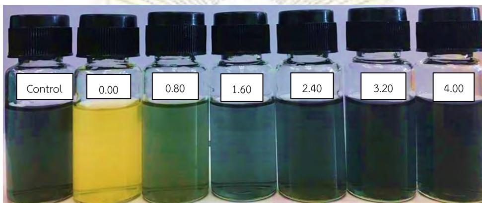
รูปที่ 3.12 แสดงของสีสารละลายผสมเมื่อเวลาบ่มครบ 1 ชั่วโมง โดยสารละลายผสมมีนมผสมอยู่ 0.00, 0.80, 1.60, 2.40, 3.20, 4.00 \mu\text{L} ตามลำดับ
