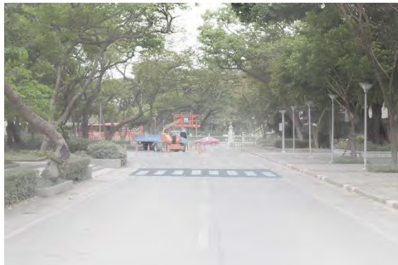
รูปภาพที่ 6.12 ภาพถ่ายจำลองการมองเห็นเลือนรางระดับ 2 ทางม้าลายพื้นสีน้ำเงิน ระยะ 25 เมตร
