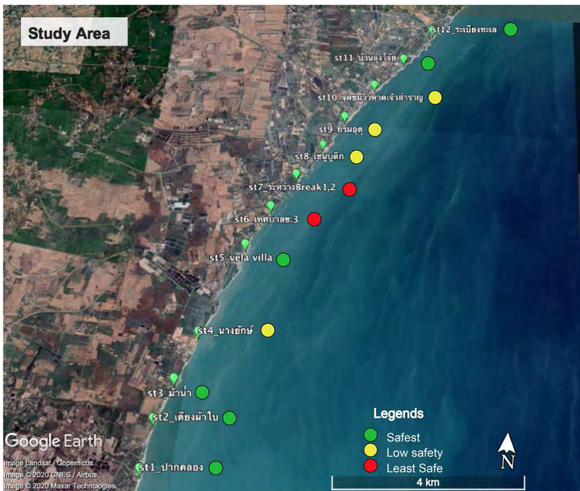
ภาพที่ 5.6: แผนที่แสดงระดับความรุนแรงของการเกิดกระแสน้ำป่วนในช่วงฤดูมรสุมตะวันออกเฉียงเหนือ
