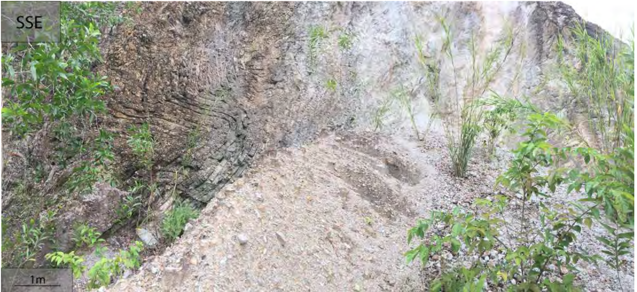
รูป 4.10 (a) รูปถ่ายหินโคลนในตำแหน่งศึกษาขอบเขตที่ 2 (b) ลักษณะธรณีวิทยาโครงสร้างของพื้นที่เส้นสีเทาแสดงชั้นหินคดโค้งนอนทับ (recumbent fold) โดยมีค่าระนาบแกน (axial plane) 218/26 WNW โดยมีรอยเลื่อนที่ตัดผ่านชั้นหินคดโค้งนี้โดยมีค่าการวางตัว 270/26 N โดยแสดงลักษณะของ และ พื้นที่เส้นสีดำแสดงลักษณะของรอยเลื่อน และ พื้นที่สีชมพูคือลักษณะของ พนังควอตซ์ (quartz dike)
