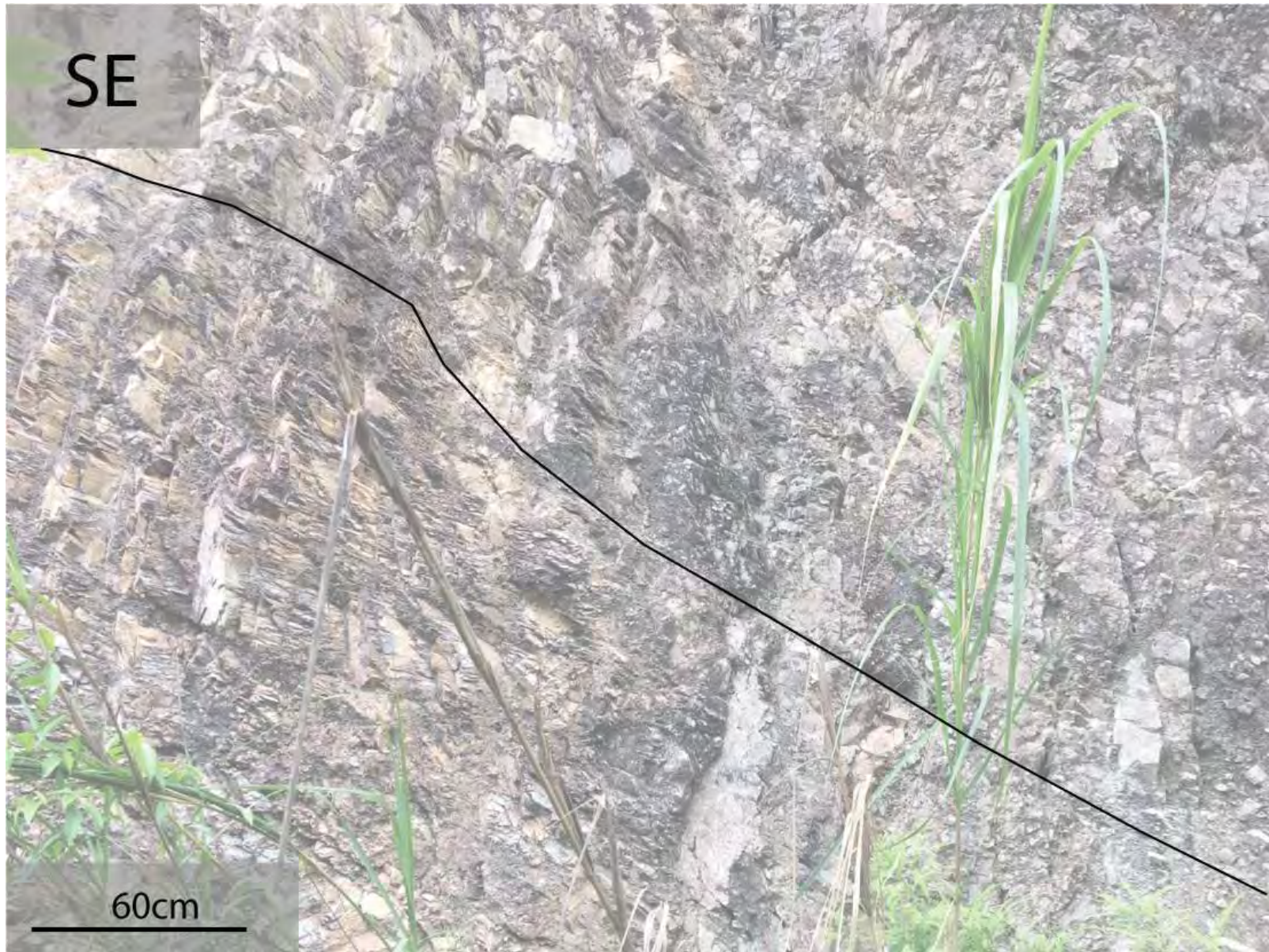
รูป 4.8 (a) รูปถ่ายหินโพลในตำแหน่งศึกษาขอบเขตที่ 1 (b) ลักษณะธรณีวิทยาโครงสร้างของรอยเลื่อนที่ไม่ทราบทิศทางการวางตัวซึ่งเป็นรอยเลื่อนเดียวกับรอยเลื่อนของ(รูป 4.9)
