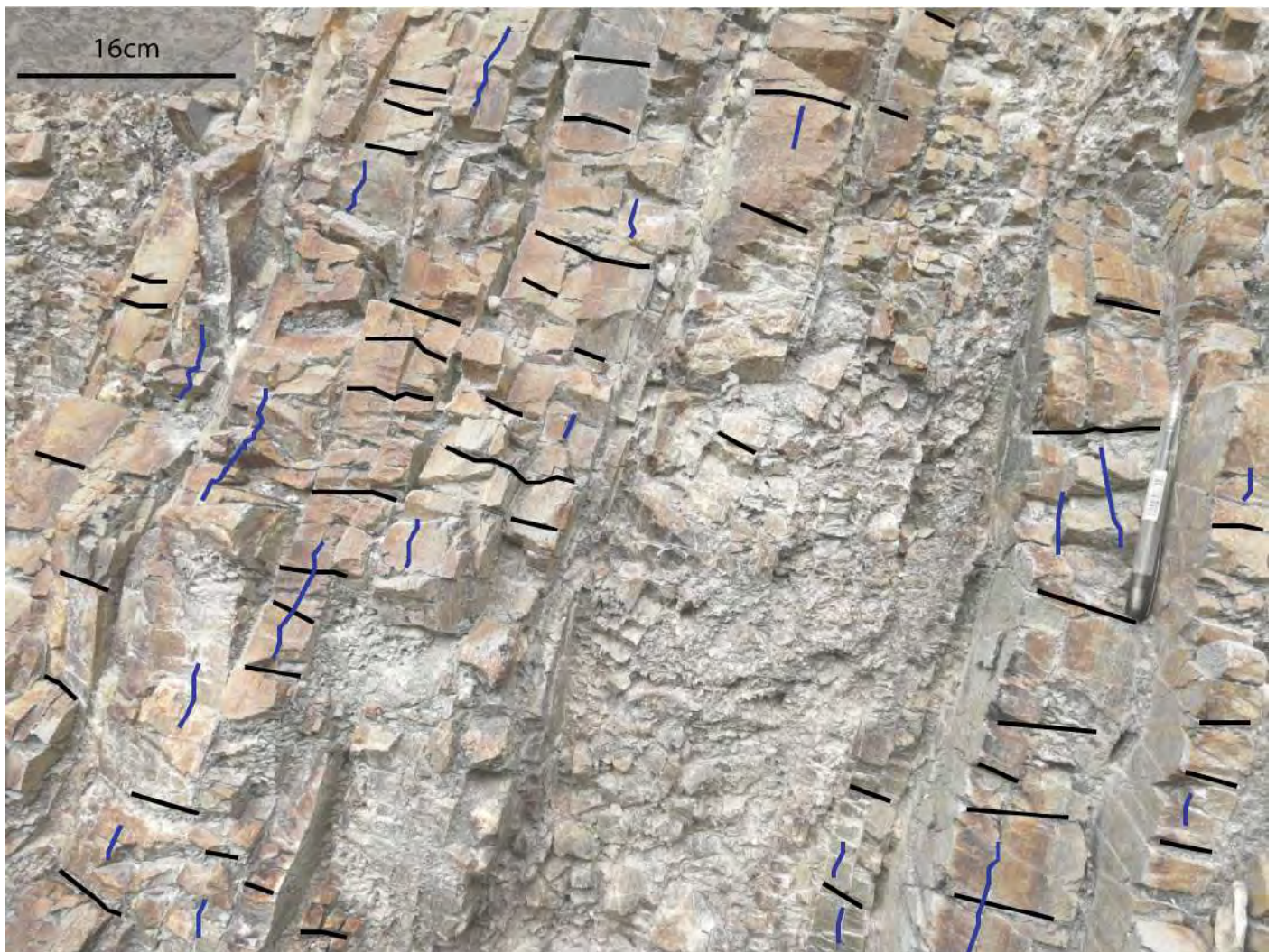
รูป 4.13 แสดงลักษณะของกลุ่มแนวแตก (joint set) ที่พบในพื้นที่ศึกษา
