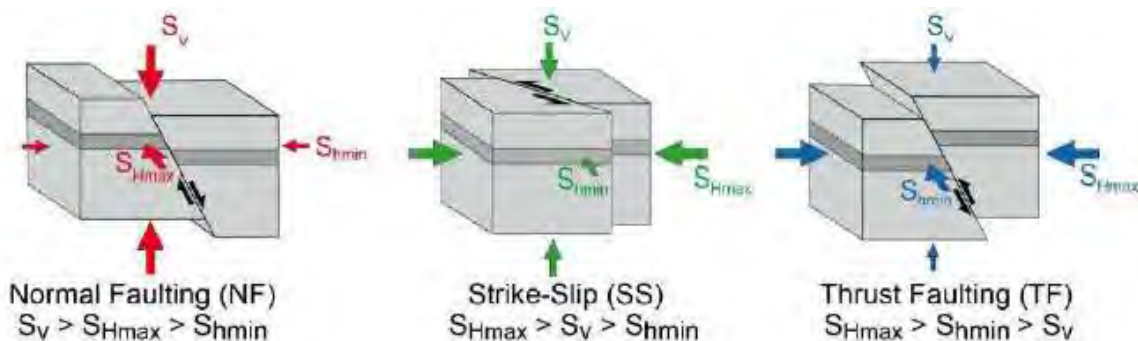
รูปที่ 2.5 แสดงทิศทางความเค้นหลักสัมพันธ์กับระบบรอยเลื่อนแต่ละประเภท
