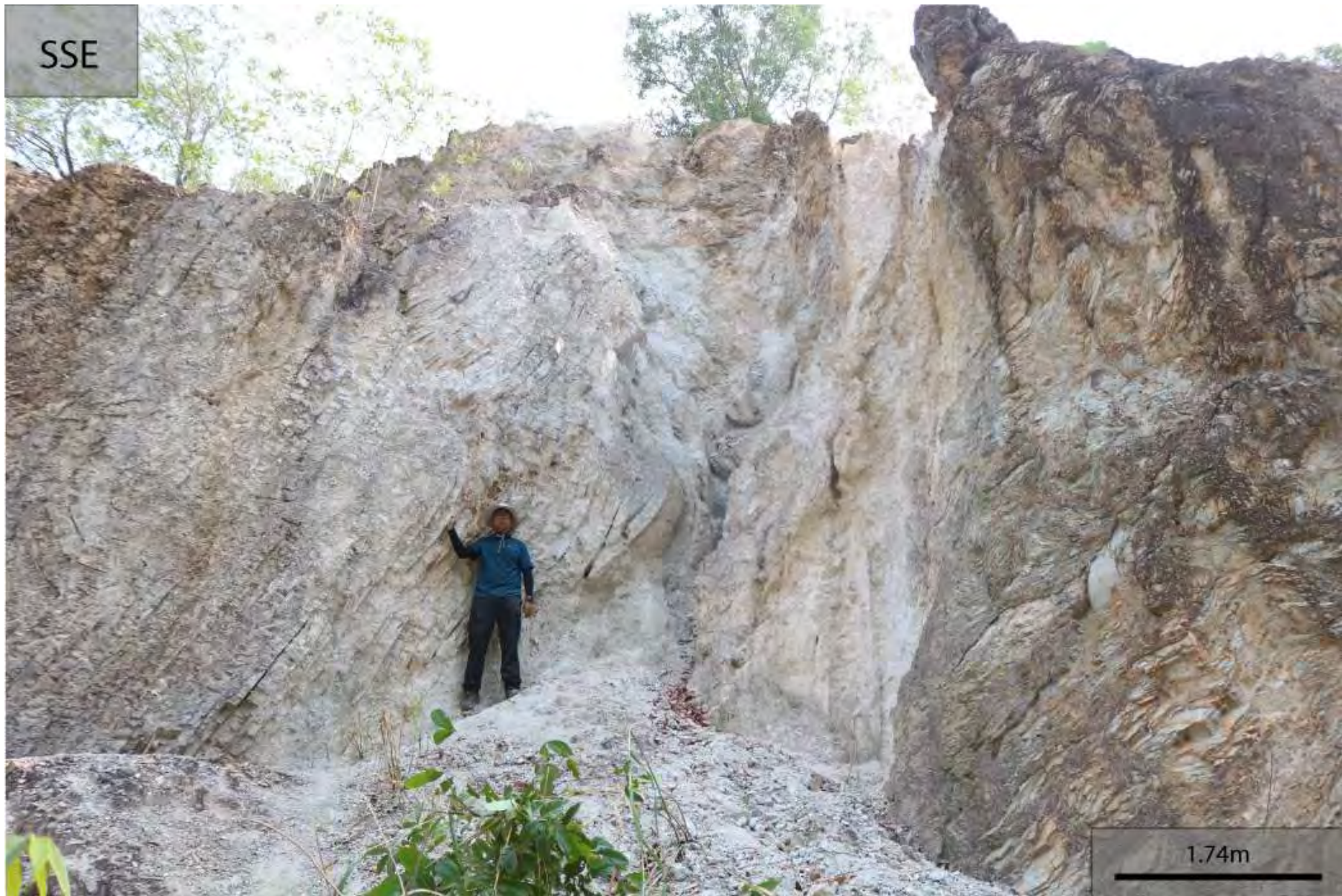
รูป 4.12 (a) รูปถ่ายหินโผล่ในตำแหน่งศึกษาขอบเขตที่ 2 (b) ลักษณะของผนังควอตซ์ที่แทรกผ่านชั้นหินในขอบเขตที่ 2 วัดค่าวางตัวได้ 241/69 NNW
