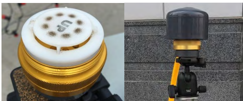
ภาพที่ 3.4 เครื่องมือ Cascade impactor ที่ใช้ในการเก็บฝุ่นตัวอย่าง
