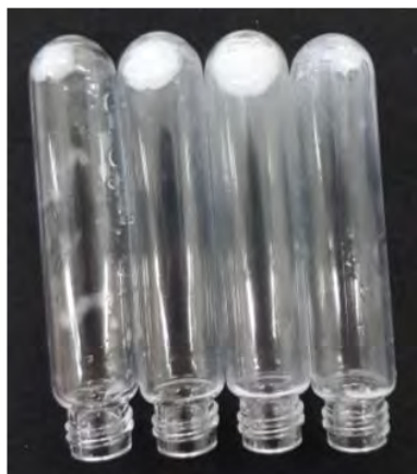
ภาพที่ 12 หลอดขนาด 10.4 มิลลิลิตรที่เกิดความเสียหาย
