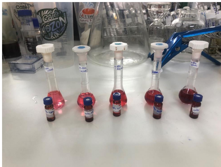
ภาพ ค-1: การเตรียม calibration curve ที่ความเข้มข้น 10, 20, 40, 80, 160 ppm
