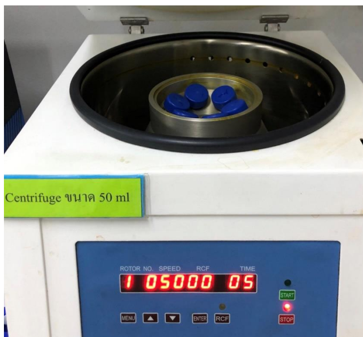
ภาพ ก-3: แยกส่วนของแข็งและของเหลวด้วยเครื่องหมุนเหวี่ยง
