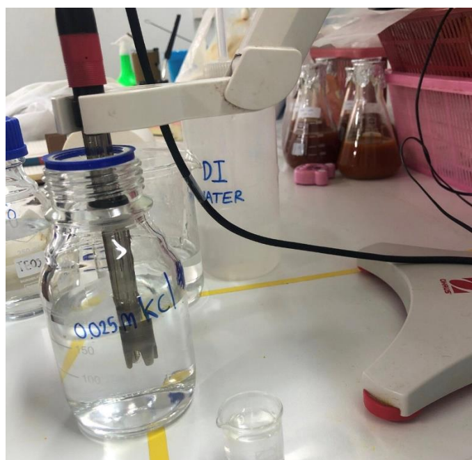
ภาพ ข-2: การปรับ pH ของบัฟเฟอร์สำหรับตรวจวัด pH-differential
