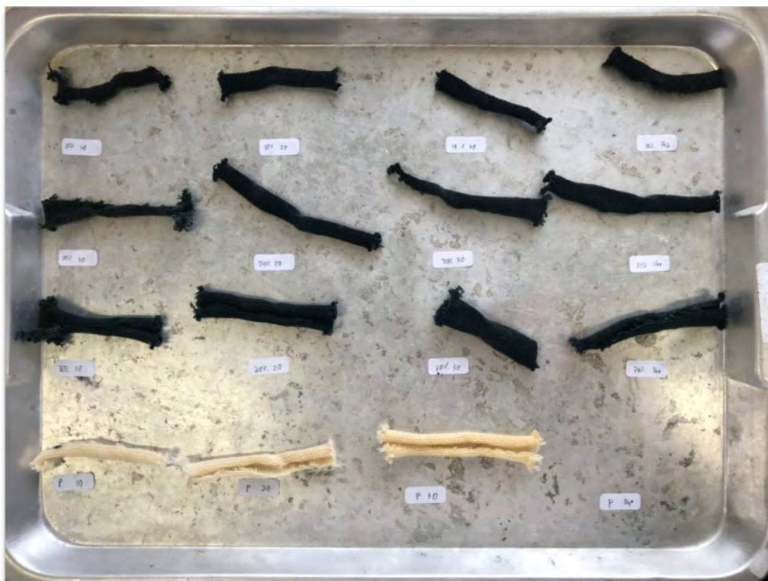
รูปที่ 4.2 ผ้าอะคริลิกที่ถูกเคลือบด้วยพอลิอะนิลีนที่ความเข้มข้น (a)10%, (b)20%, (c)30% และทำการstabilization ที่อุณหภูมิ180 °C ที่เวลา10นาที ,20นาที ,30นาที และ1 ชั่วโมง
