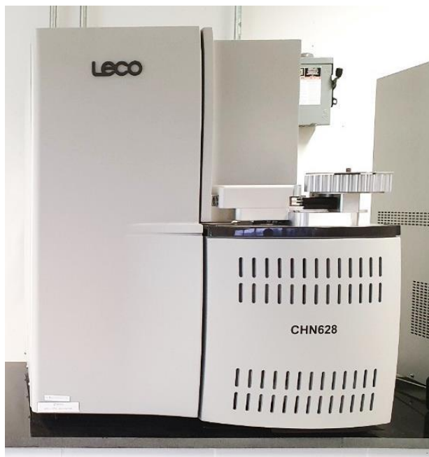
รูป 3.5 เครื่องวิเคราะห์ธาตุ CHN (CHN analysis)
