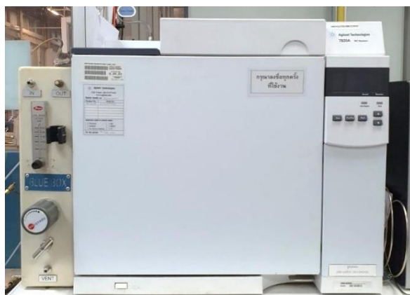
รูป 3.3 เครื่องแก๊สโครมาโทกราฟี (GC-TCD)
