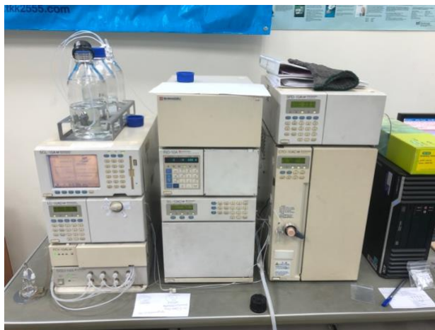
รูปที่ 3.3 แสดงเครื่อง High performance liquid chromatograph (HPLC) ยี่ห้อ HPX-87H
