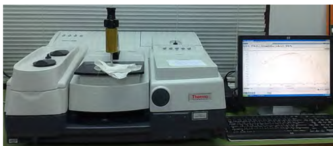
รูปที่ 3.1 เครื่อง Fourier transform infrared spectroscopy รุ่น Nicolet 6700
