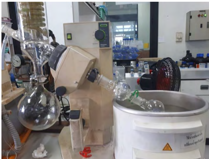
ภาพที่ 3-2 การระเหย Diethyl ether ด้วยเครื่องระเหยแบบหมุน (Rotary evaporator)
