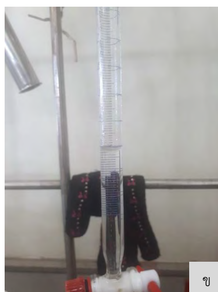
ภาพที่ 3-1 การสกัดน้ำมันหอมระเหยจากใบกะเพราขาวด้วยชุดสกัดด้วยการต้มกลั่น (Clevenger type apparatus) (ก) โดยน้ำมันที่ได้จะแยกชั้นกับน้ำอย่างชัดเจน (ข)
