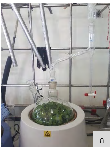
ภาพที่ 3-1 การสกัดน้ำมันหอมระเหยจากใบกะเพราขาวด้วยชุดสกัดด้วยการต้มกลั่น (Clevenger type apparatus) (ก) โดยน้ำมันที่ได้จะแยกชั้นกับน้ำอย่างชัดเจน (ข)
