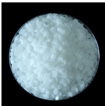
รูปที่ 6 พอลิเอทิลีนแวกซ์ที่มีลักษณะเป็นเม็ด
