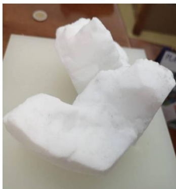
รูปที่ 4 พอลิเอทิลีนแวกซ์ที่มีลักษณะเป็นก้อน
