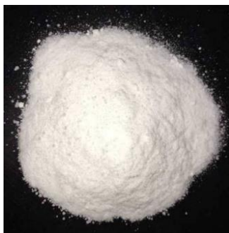
รูปที่ 7 พอลิเอทิลีนแว็กซ์ที่มีลักษณะเป็นผง
