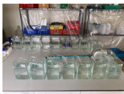
ภาพที่ ก-3 การติดตั้งอุปกรณ์ที่ใช้ในการทดลอง ได้แก่ ตู้กระจก น้ำทะเลที่ผ่านการกรอง สายยาง พาสเจอร์ไรเปต และปั๊มลมให้อากาศ
