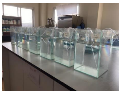
ภาพที่ ก-3 การติดตั้งอุปกรณ์ที่ใช้ในการทดลอง ได้แก่ ตู้กระจก น้ำทะเลที่ผ่านการกรอง สายยาง พาสเจอร์ไรเปต และปั๊มลมให้อากาศ
