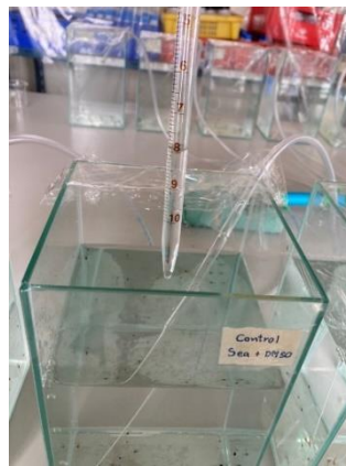
ภาพที่ ๓-6 การเติมสารละลายเบนโซฟีโนน-3 ลงในแต่ละตู้ เมื่อเริ่มการทดลอง
