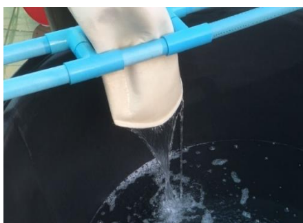
ภาพที่ 3-3 การเตรียมน้ำทะเลด้วยถุงกรอง
