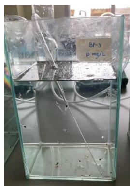
ภาพที่ ก-4 การนำกุ้งขาวใส่ตู้กระจกที่ติดตั้งไว้ก่อนเริ่มทำการทดลองเพื่อปรับสภาพ
