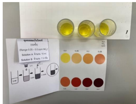
ภาพที่ ๘-9 การวัดค่าไนไตรท์ในน้ำทะเลที่ใช้ทดลอง ด้วยชุดวัดค่าไนไตรท์ AQUA VBC (nitrite test kit)
