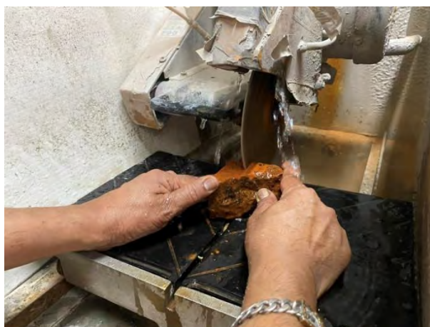
รูป 2.2 ตัวอย่างอิฐที่ถูกตัดในแนวด้านกว้างด้วยเครื่องตัดหินเจียร์
