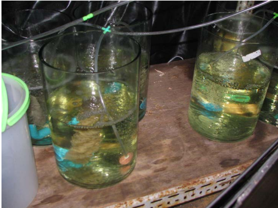
รูปที่3-6 การทดสอบไซกรองจากบ่อกรองทางชีวภาพไนตริฟิเคชัน ความยาว 15 เซนติเมตร ในโหลแก้วปริมาตรน้ำ 8 ลิตรเพื่อทดสอบอัตราการบำบัดแอมโมเนีย
