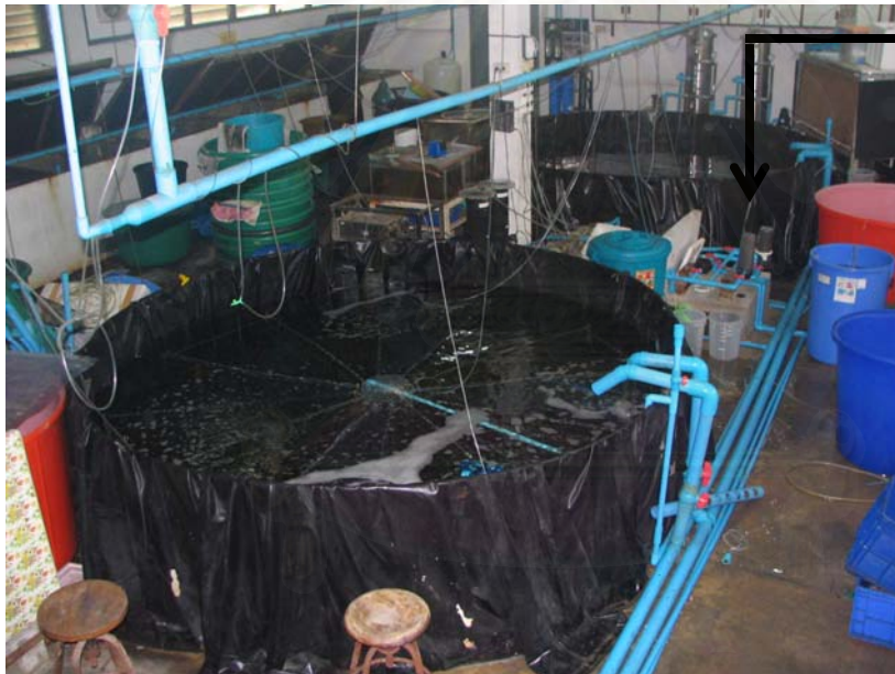
รูปที่3-1 ลักษณะการติดตั้ง (1) ระบบกรองตะกอนขนาดรูพรุนของไส้กรอง 5 ไมครอน กับปล่อยกึ่งรูปกลมที่ใช้ในการทดลอง
