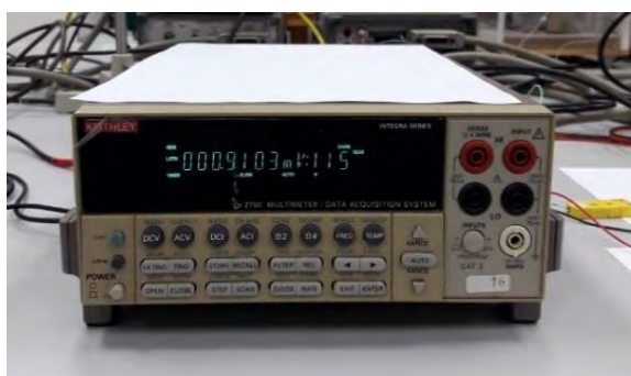
รูปที่ 3.6: (ซ้าย)เครื่องมัลติมิเตอร์ (Keithley 2700 + Scanner 7710) และ (ขวา)ตัวต้านทานปรับค่าได้
