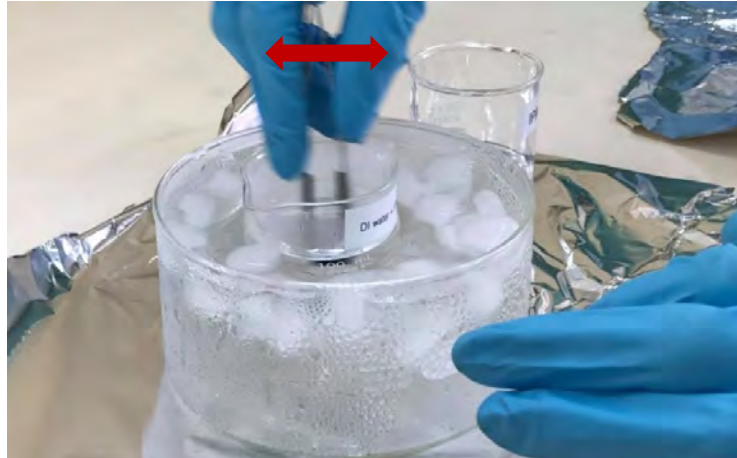
รูปที่ 29 วิธีการเขย่า tweezer ในปีกเกอร์ที่มี developer
