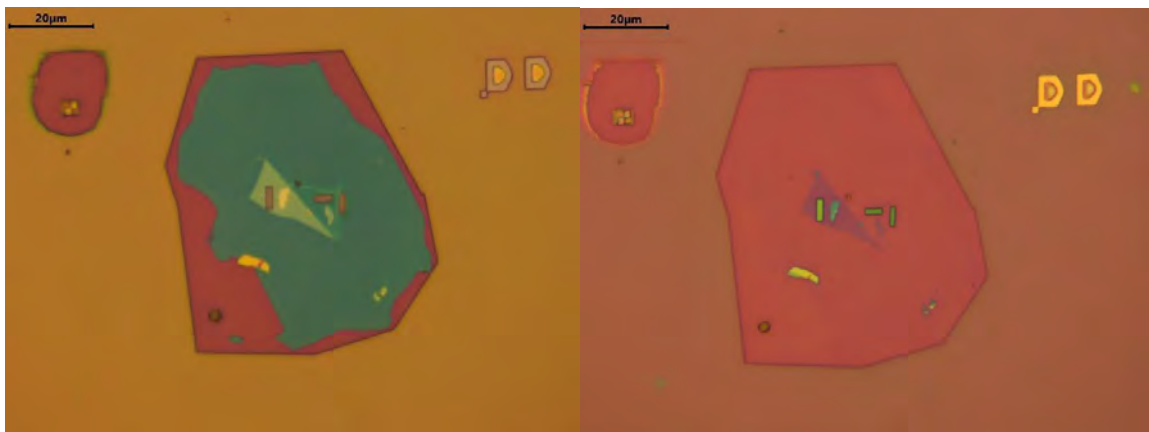
รูปที่ 31 แสดงก่อน (ซ้าย) และหลัง (ขวา) การทำ Plasma etching
