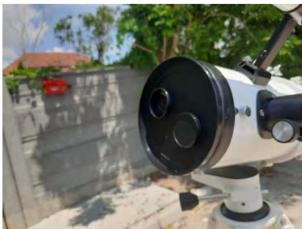
รูปที่ 23 การปิดฝากล้องขณะใช้กล้องมองดวงอาทิตย์
