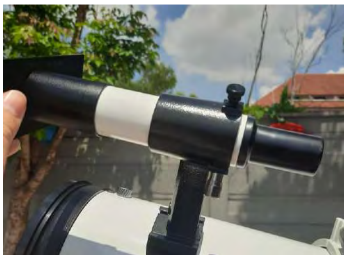
รูปที่ 24 การใช้กล้องส่องดวงอาทิตย์ ต้องมองผ่านกระจกดำ เพื่อป้องกันดวงตาได้รับความเสียหายจากการมอง
