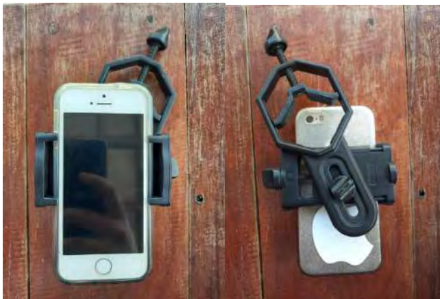
รูปที่ 25 การยึดโทรศัพท์กับตัวยึด
