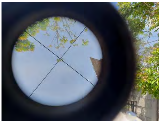
รูปที่ 22 การเล็งวัตถุให้อยู่ตรงกลางของกล้องเล็ก
