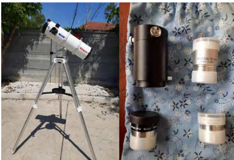
รูปที่ 18 แสดงกล้องและขาตั้งกล้อง (ซ้าย) ตัวยึด eyepiece และ eyepiece (ขวา)
