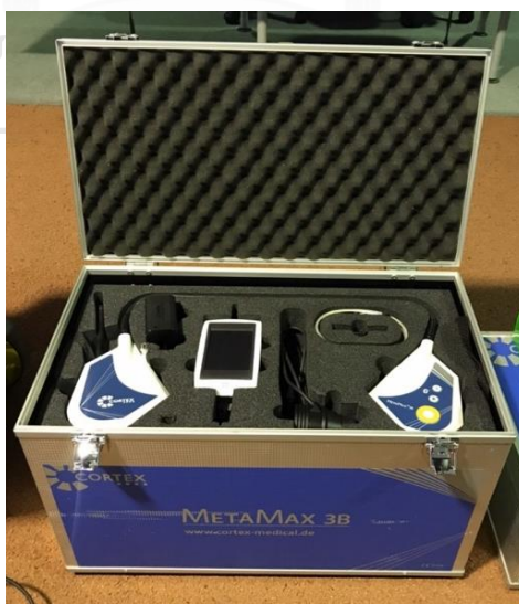
รูปที่ 11 เครื่องวิเคราะห์แก๊ส (breath by breath Cardiopulmonary gas exchange system) ยี่ห้อคอร์เทกซ์ (cortex) รุ่นเมทาแม็กซ์ ทรีบี (metamax® 3B) ประเทศเยอรมัน
