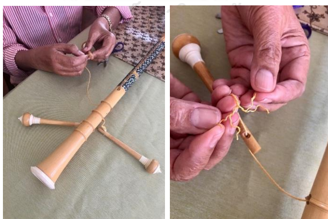
ภาพที่ 6 ลดสายทั้งสาม ถอดลูกบิดออกจากสลัก
