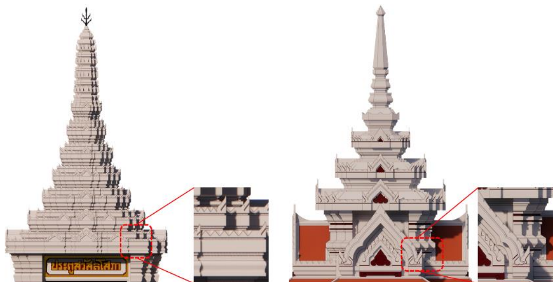
ภาพที่ 5-34 การลบบวม ปาดมุม ในองค์ประกอบสถาปัตยกรรม
