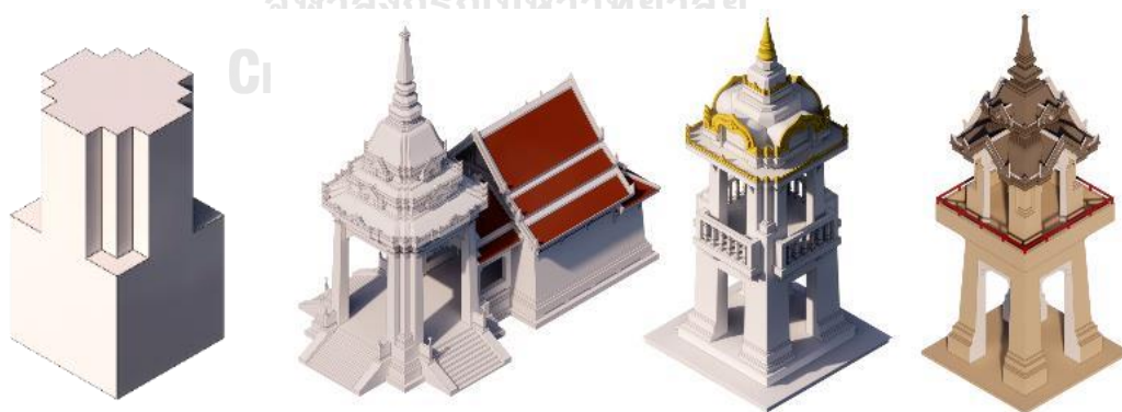
ภาพที่ 4-18 วิธีการย่อมุมในงานออกแบบของพระพรหมพิจิตร (ซ้าย) เมรุถาวร วัดไตรมิตรวิทยาราม (กลาง) หอระฆัง วัดยานนาวา (ขวา) หอระฆัง วัดพระศรีมหาธาตุ บางเขน (ที่มา: ผู้วิจัย, 2565)
