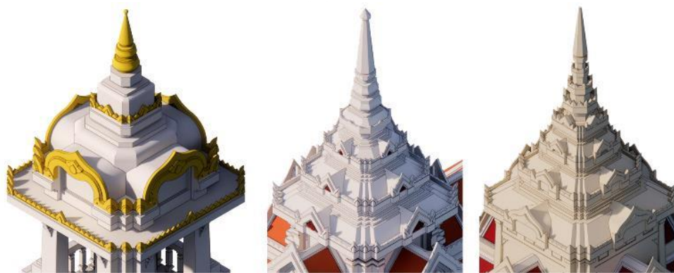
ภาพที่ 4-19 วิธีการลบมุมในงานออกแบบของพระพรหมพิจิตร (ซ้าย) หอรณะวัง วัดยานนาวา (กลาง) เมรุถาวร วัดจักรวรรดิราชาวาส (ขวา) แบบร่างศาลหลักเมือง จังหวัดสุพรรณบุรี (ที่มา: ผู้วิจัย, 2565)
