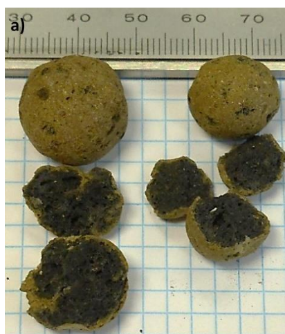
รูปที่ 4 เม็ดดินเผาฟองตัวซึ่งมีโครงสร้างแบบ core-shell structure [58]
