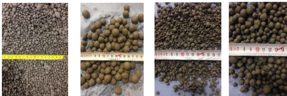
รูปที่ 6 เม็ดมวลรวมเบาขนาดต่าง ๆ จากงานวิจัยของ Tang และคณะ [55]
