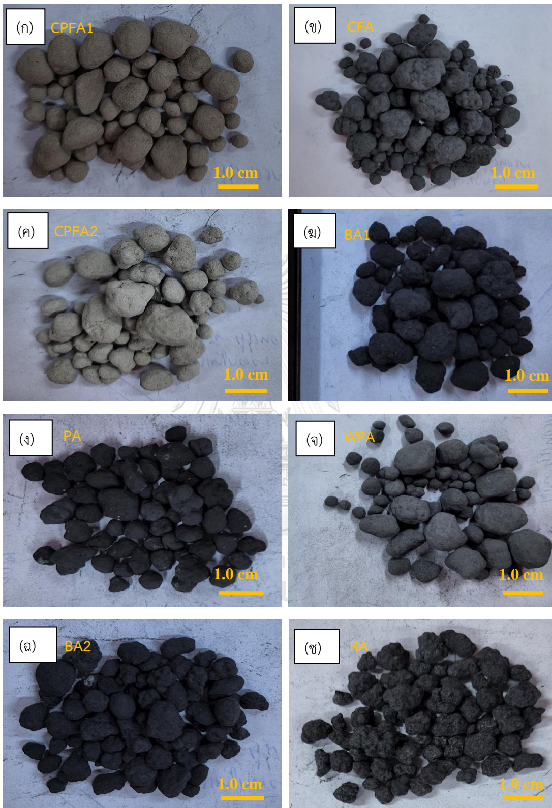
รูปที่ 25 ตัวอย่างเม็ดมวลรวมเบาที่เตรียมจาก (ก)เม็ดลอย CPFA1 (ข)เม็ดลอย CFA (ค)เม็ดลอย CPFA2 (ง)เม็ด BA1 (จ)เม็ด PA (จ)เม็ดลอย WFA (ฉ)เม็ด BA2 และ (ช)เม็ด RA
