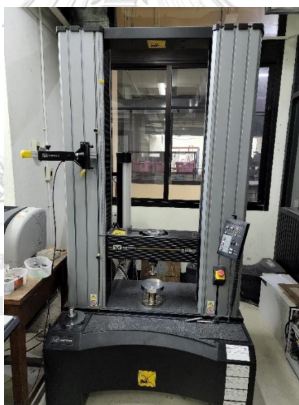
รูปที่ 13 เครื่อง Universal testing machine (UTM)
