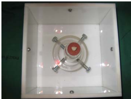
ภาพที่ 19 นำฟันที่ยึดในแท่งจุกยางไปยึดกับอุปกรณ์ที่ช่วยในการยึดขาควให้แน่น
