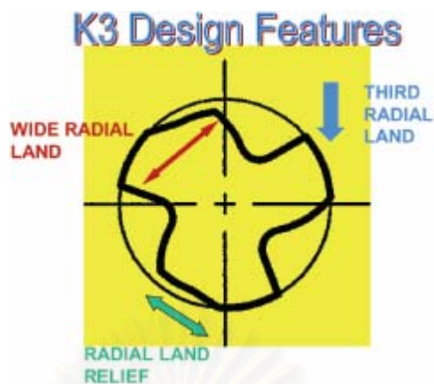
ภาพที่ 6 ไบต์ดที่สาม (third radial land) และบางส่วนไบต์ดลดการสัมผัสกับผิวฟัน (radial land relief) ของเคทรี
