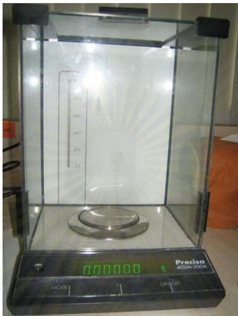
ภาพที่ 9 เครื่องชั่งน้ำหนักอิเล็กทรอนิกส์ระบบดิจิทัล (40SM-200A, Precisa, Precisa Gravimetrics AG, Moosmattstrasse 32, Dietikon, Switzerland) ความละเอียด 0.00001 กรัม
