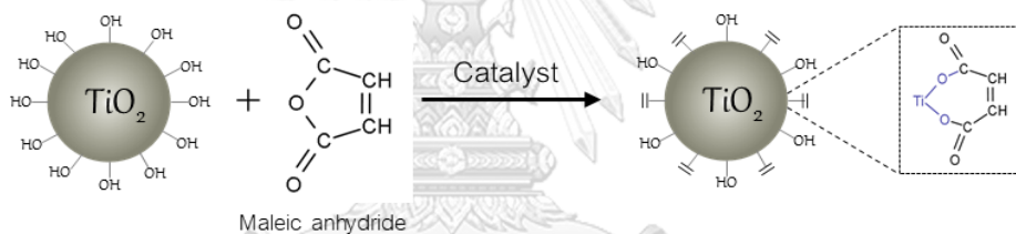
รูปที่ 2.24 กลไกการตัดแปรไทเทเนียมไดออกไซด์ด้วยมาเลอิกแอนไฮไดรด์ [55]
