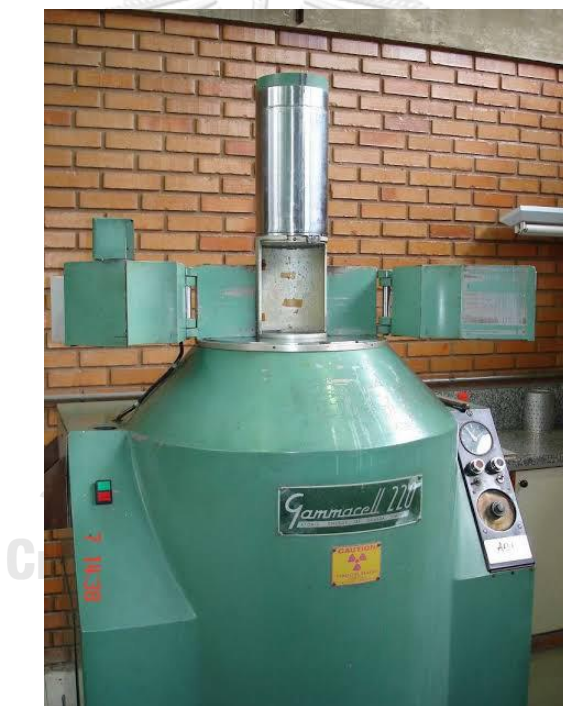
รูปที่ 3.1 เครื่องฉายรังสีแกมมาจากแหล่งกำเนิดรังสีโคบอลต์-60 ยี่ห้อ Gammacell 220
