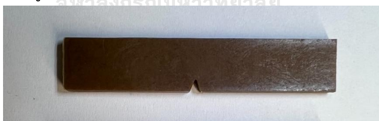
รูปที่ 3.6 ชิ้นทดสอบความทนแรงกระแทกตามมาตรฐาน ASTM D256
