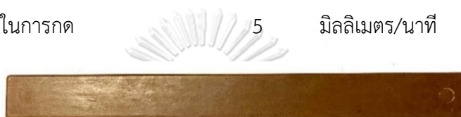
รูปที่ 3.9 ชิ้นทดสอบสมบัติด้านแรงดัดโค้งตามมาตรฐาน ASTM D790
