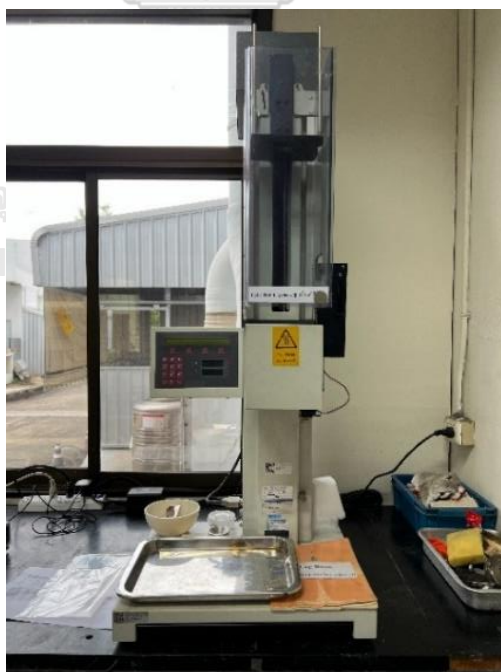
รูปที่ 3.4 เครื่องทดสอบดัชนีการหลอมไหล (MFI)
