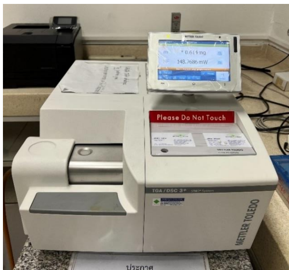
รูปที่ 3.12 เครื่องวิเคราะห์น้ำหนักภายใต้ความร้อน (ทีจีเอ)
