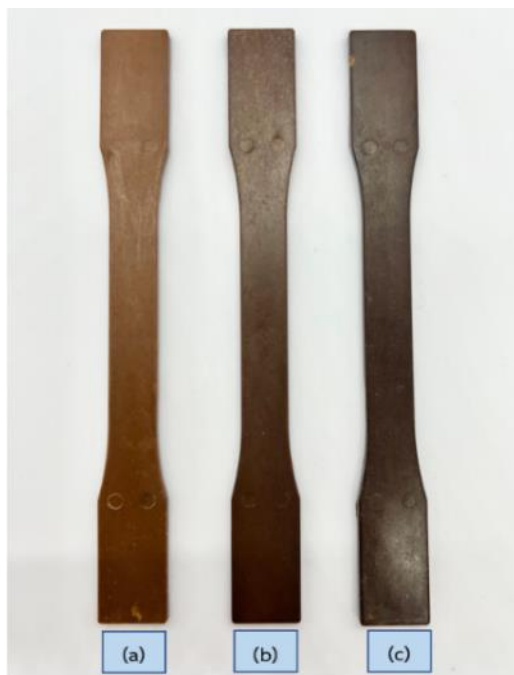
รูปที่ 4.2 ชิ้นทดสอบของคอมพอสิต 70/30 r-PET/TPU ด้วย WF ที่อัตราส่วน WF: (a) 10, (b) 20 และ (c) 30 phr
