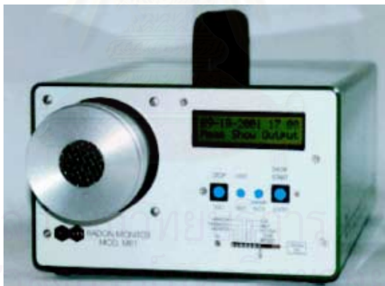
รูปที่ 2.4 แสดง model AB – 4 (A) portable radon monitor (Lucas cell)
