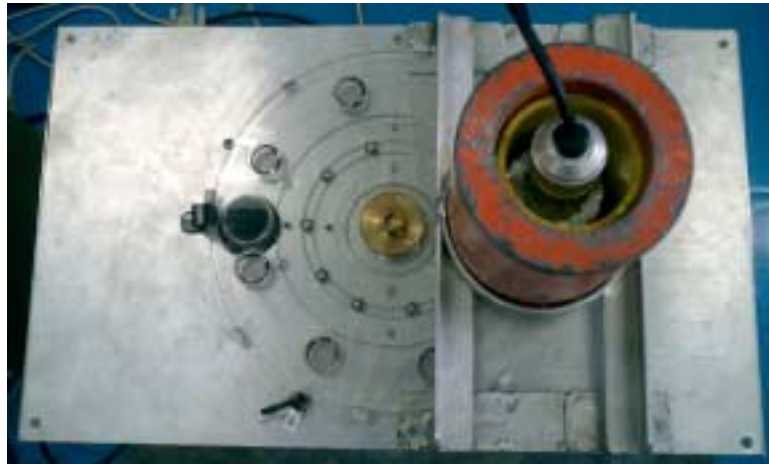
รูปที่ 3.11 ภาพด้านบนของระบบตรวจวัดความเข้มข้นของเรดอน-222 ในอากาศชนิดเคลื่อนย้าย ได้
