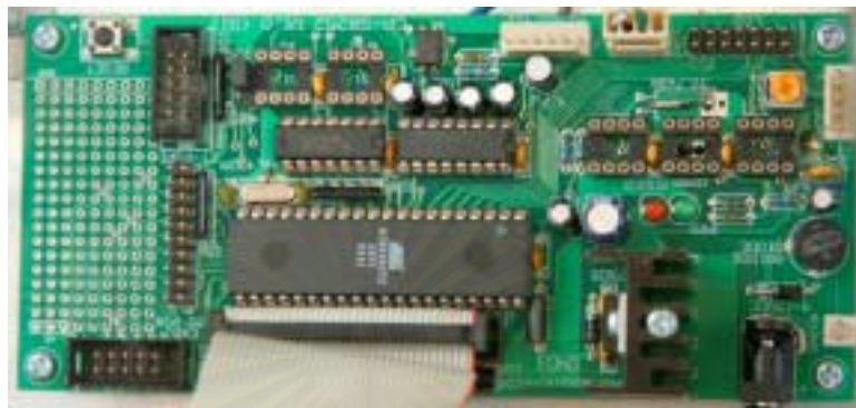
รูปที่ 3.10 บอร์ดสำเร็จรูปจากบริษัท อีทีที จำกัด model CP-S8252 V1.0 [11]
