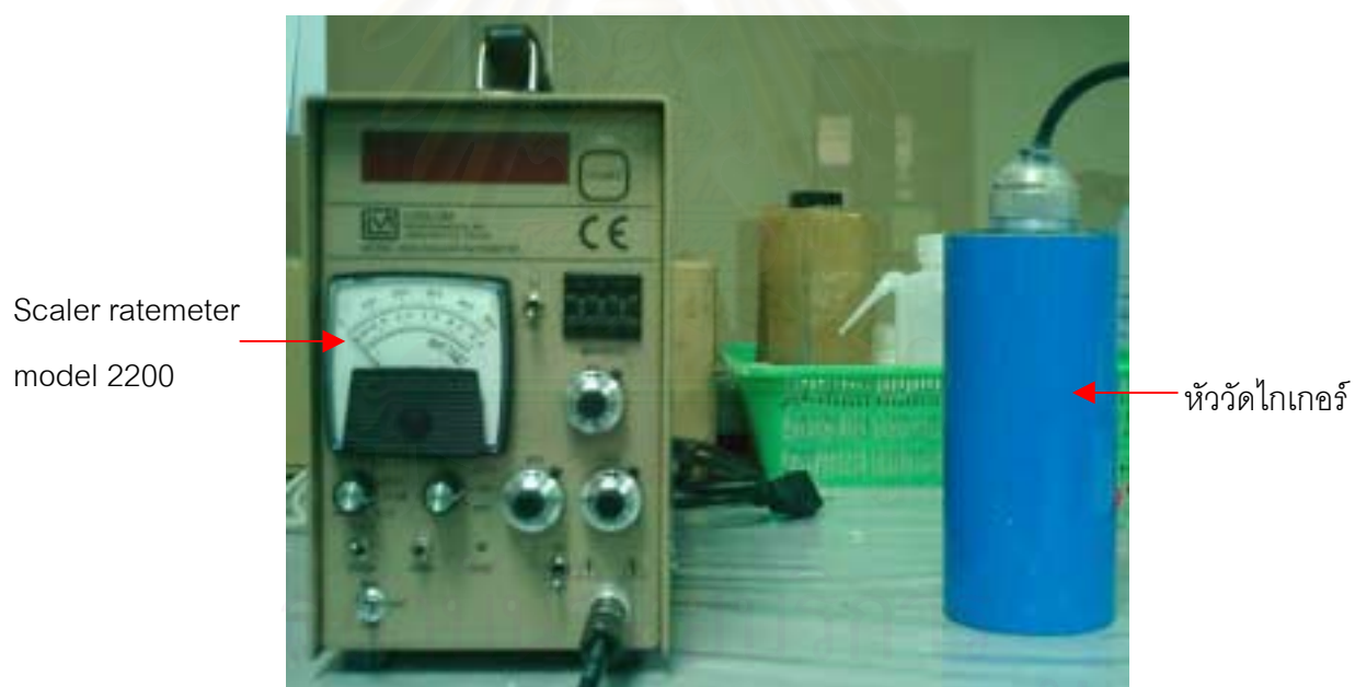
รูปที่ 3.5 Scaler ratemeter model 2200 ของบริษัท Ludlum จำกััดและหัววัดไกเกอร์ขนาด 3 นิ้ว
