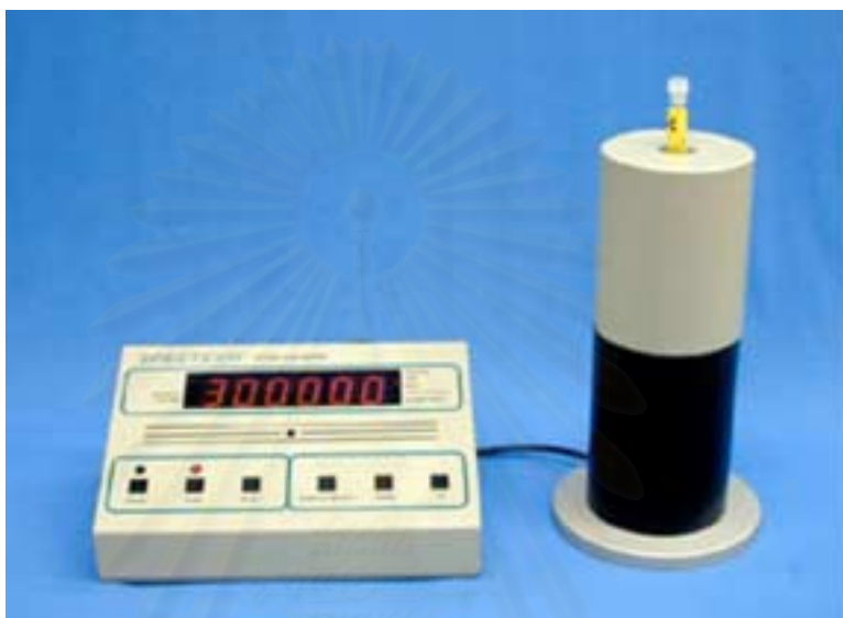
รูปที่ 2.6 แสดงหัววัดรังสีชนิดซินทิลเลชัน (Scintillation counter) [8]
