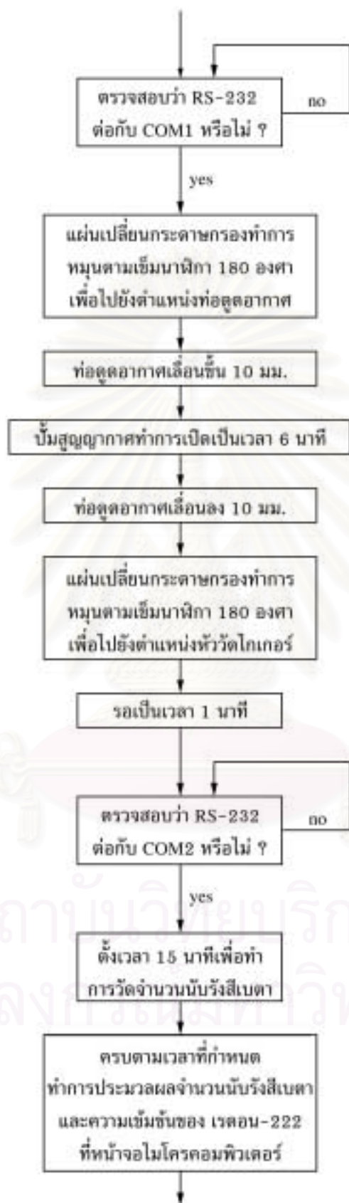
รูปที่ 3.15ผังไหลของโปรแกรมควบคุมการทำงานของระบบตรวจความเข้มข้นของเรดอนโดยการวัดรังสีเบตา (ต่อ)
