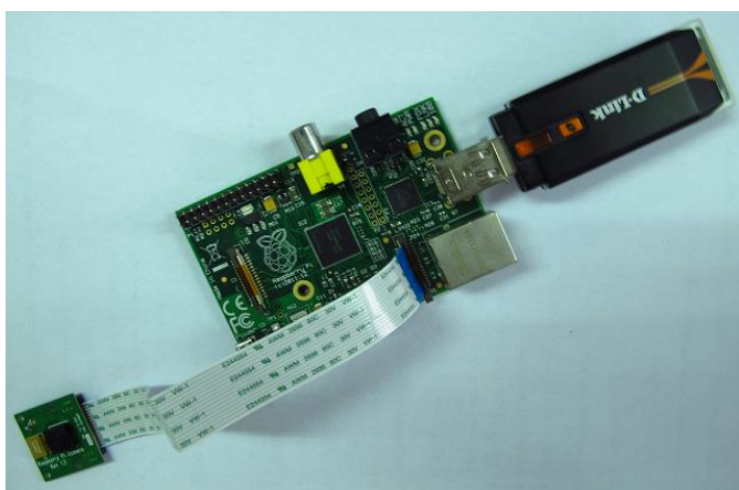
รูปที่ 3.13 อุปกรณ์ Wireless Indoor Electric Appliances Monitor (WIEAM)
