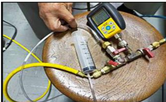
รูปที่ 3.8 วาล์วรูปตัวที ( T ) และมิเตอร์วัดความดันสุญญากาศ
