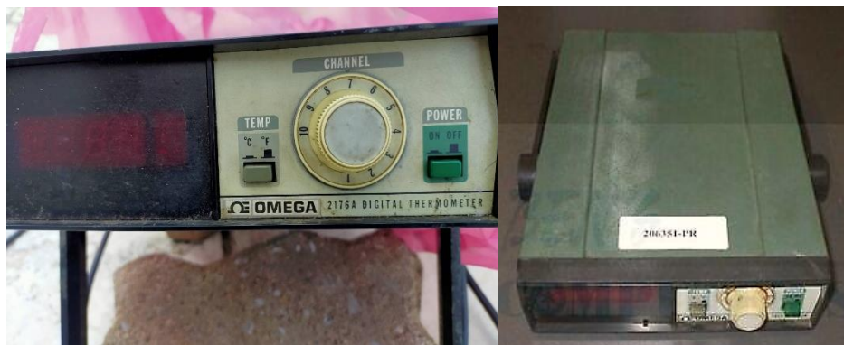
รูปที่ 3.12 เครื่องวัดอุณหภูมิแบบเทอร์โมคัปเปิ้ล
