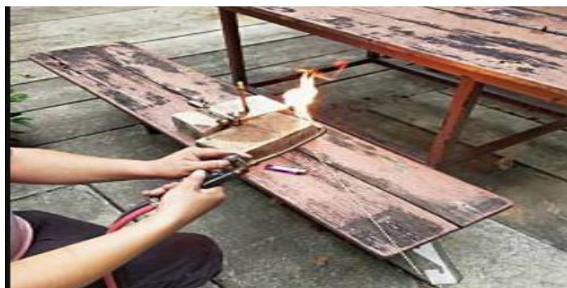
รูปที่ 3.7 การเชื่อมส่วนประกอบต่างๆเข้ากับท่อทองแดง
