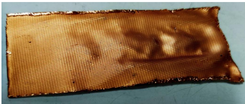
รูปที่ 3.4 เกลียวภายในท่อทองแดงเมื่อผ่าท่อและคลี่ให้เป็นแผ่น
