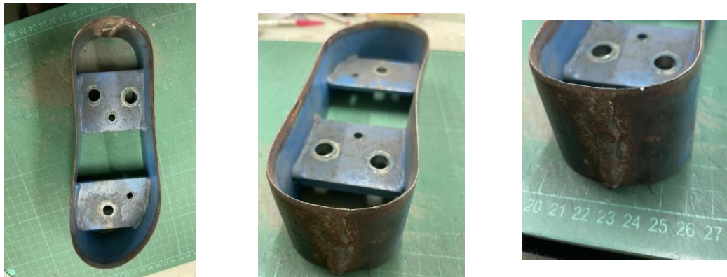
รูปที่ 1.4 ลักษณะตายที่มีรอยป็นและขึ้นสนิม
