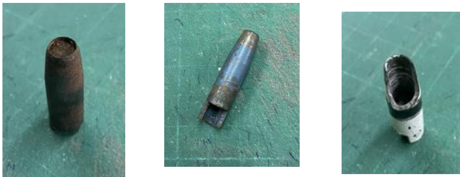
รูปที่ 1.6 ลักษณะฟันซ์ที่มีรอยป็น การสึกหรอและขึ้นสนิม
