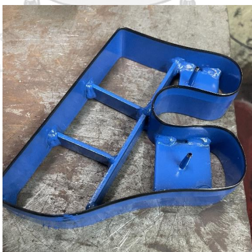
รูปที่ 1.1 แม่พิมพ์แบบตัด
