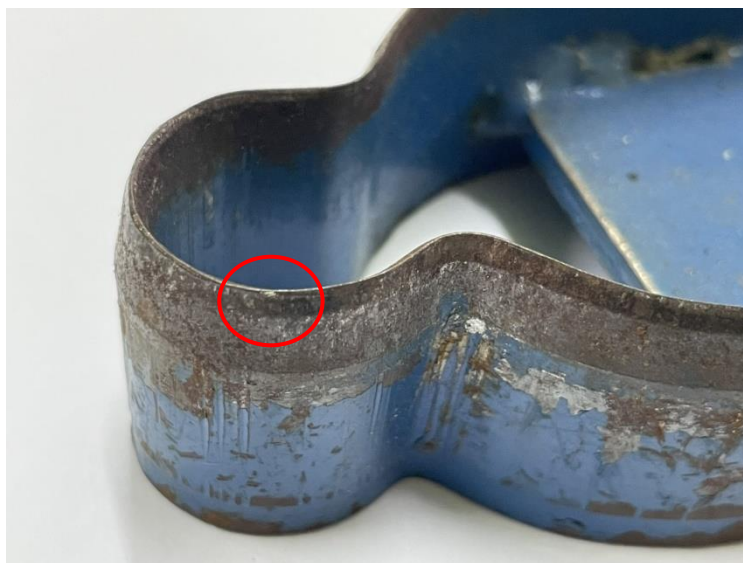
รูปที่ 7.19 ตัวอย่างการสึกหรอของแม่พิมพ์ที่ไม่มีการเคลือบผิวและไม่มีการใช้น้ำมันหล่อลื่น
