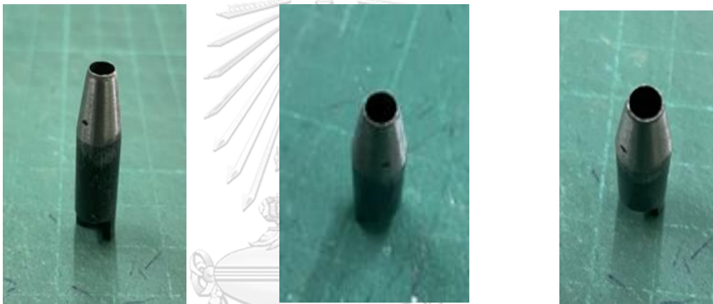
รูปที่ 1.5 ลักษณะฟันซ์ทั่วไปที่ใช้ในกระบวนการผลิตแม่พิมพ์แบบตัด
