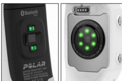
ภาพที่ 33 แสดงเซ็นเซอร์แสงสีเขียวสำหรับวัดอัตราการเต้นของหัวใจ
