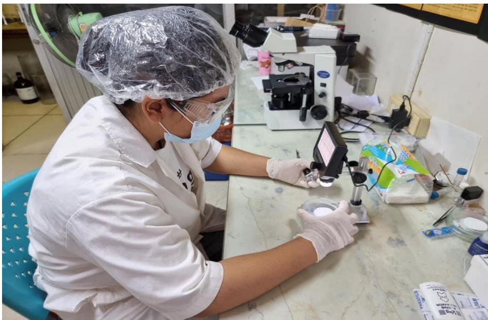
ภาพที่ 3.17 ส่องนับไมโครพลาสติกที่สะสมในเยื่อหอยนางรมบนแผ่นกรอง cellulose nitrate membranes 0.45 \mu\text{m} ภายใต้อุปกรณ์กล้องจุลทรรศน์ (stereo microscope)
