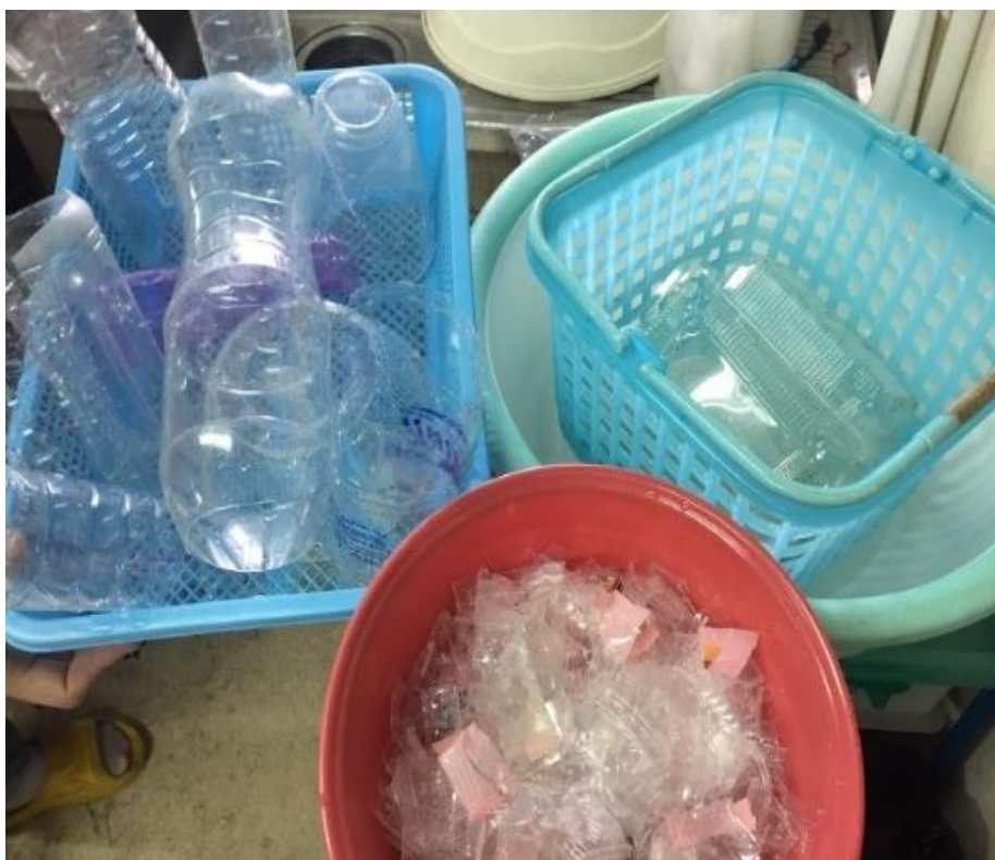
ภาพที่ 3.2 ตัวอย่างขยะพลาสติกประเภทพอลิโอสไตรีนที่ขัดล้างและทำความสะอาดแล้ว
