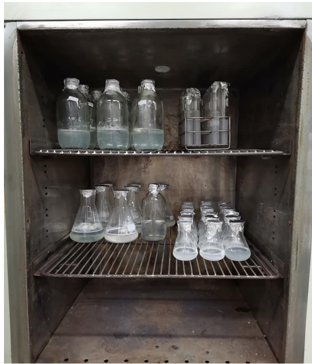
ภาพที่ 3.14 ตู้อบสำหรับอุ่นสารละลายและเนื้อเยื่อหอยด้วยความร้อน 60 องศาเซลเซียส เป็นเวลา 72 ชั่วโมง
