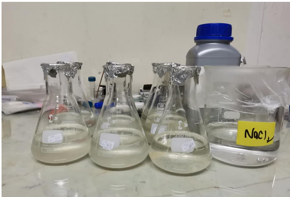
ภาพที่ 3.15 เติมสารละลายโซเดียมคลอไรด์ (NaCl) อิมิตัว เพื่อแยกไมโครพลาสติกออกจากอนุภาคอื่น ๆ
