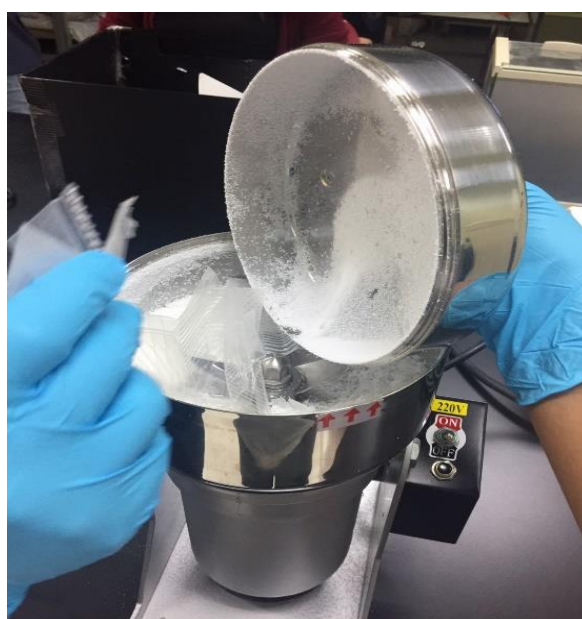
ภาพที่ 3.3 ตัวอย่างขยะพลาสติกประเภทพอลิโอสไตรีน ที่ถูกบดด้วยเครื่องเครื่องบดไมโครพลาสติกจนได้ไมโครพลาสติกจำลอง
