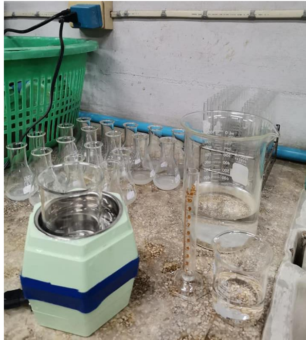
ภาพที่ 3.12 เครื่อง sonicator ใช้เพื่อชะล้างอนุภาคของไมโครพลาสติกให้หลุดออกจากบริเวณรอบนอกเนื้อเยื่อหอย
