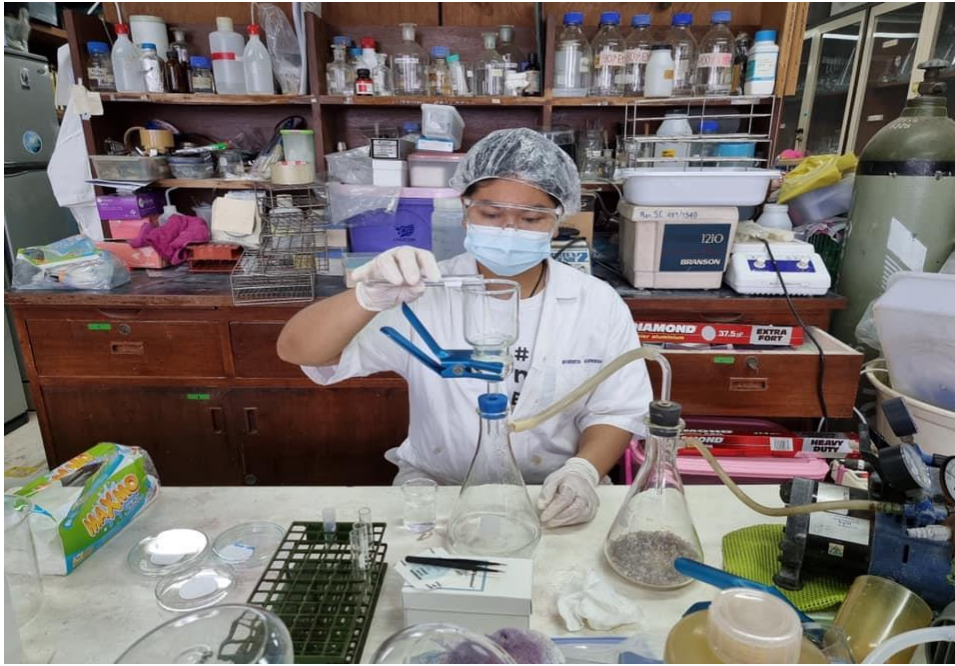
ภาพที่ 3.16 กรองสารละลายตัวอย่างผ่านกระดาษกรอง cellulose nitrate membranes 0.45 \mu\text{m}
