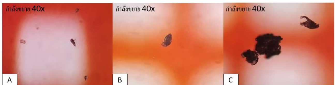
3.8 ภาพของไมโครพลาสติกจำลองประเภทพอลิสไตรีน 3 ขนาด ภายใต้กล้องจุลทรรศน์แบบใช้แสง (light microscope) กำลังขยาย 40 เท่า (A) ขนาด <30 \mu\text{m} (B) ขนาด 30\text{-}300 \mu\text{m} (C) ขนาด 300\text{-}1000 \mu\text{m}
