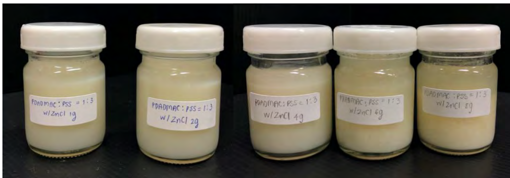
รูปที่ 4.3 การเกิดคอลลอยด์ของ PDADMAC:PSS = 1:3 ที่ ZnCl_2 1,2,4,6,8 ร้อยละโดยน้ำหนัก ตามลำดับ
