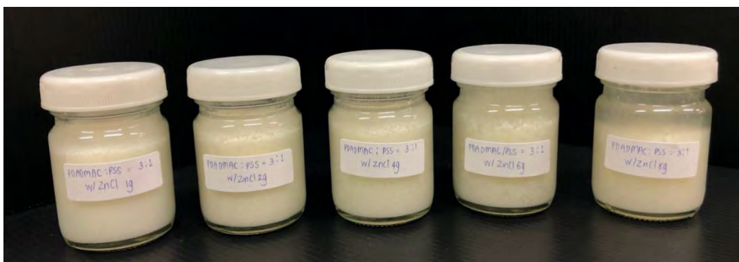
รูปที่ 4.1 การเกิดคอลลอยด์ของ PDADMAC:PSS = 3:1 ที่ ZnCl_2 1,2,4,6,8 ร้อยละโดยน้ำหนัก ตามลำดับ
