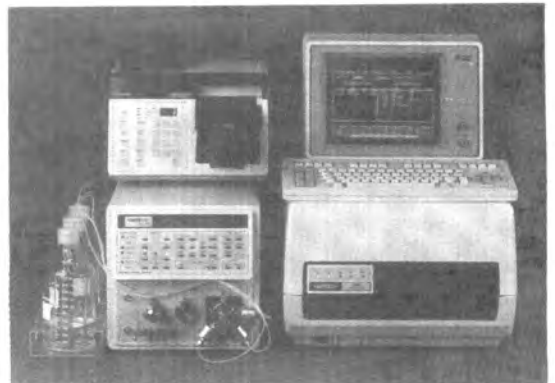
LC Star System ที่ประกอบด้วย Star 9010 Pump, 9065 Polychrom Diode Array Detector และ Advanced Automated Sample Processor (AASP)
