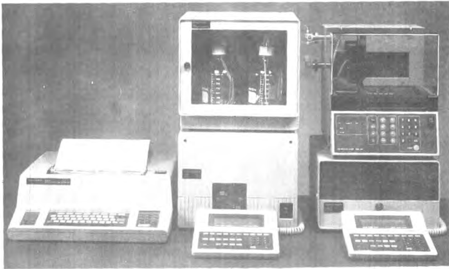
เครื่อง liquid Chromatograph ประกอบด้วย Series 410 LC Pump LC-235 Diode array detector ISS-100 Auto Sampler และ LC 1 – 100 Integrator เป็นเครื่องที่ให้สภาพไวสูง การควบคุมใช้ key board แต่ละส่วน
