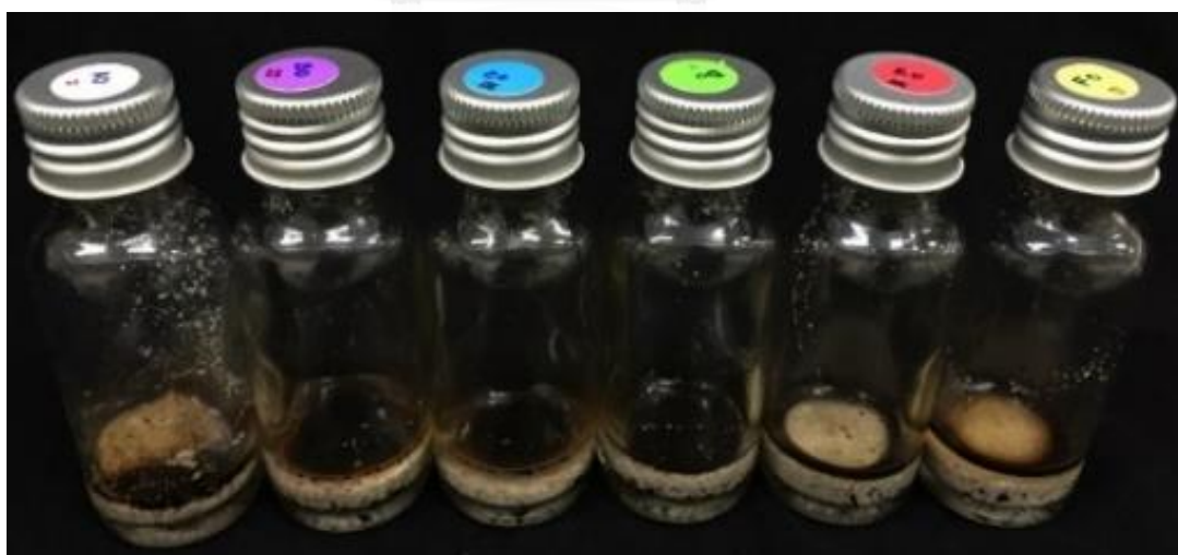
รูปที่ 3.1 ชุดทดสอบประสิทธิภาพการย่อยสลายน้ำมันดิบโดยใช้ดินทรายจากอ่าวพร้าว
