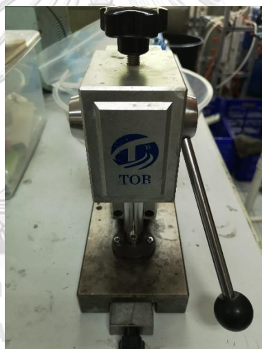
รูปที่ 3.4 เครื่องตัดเซลล์กระดุม ขนาดเส้นผ่านศูนย์กลาง 1.5 cm
