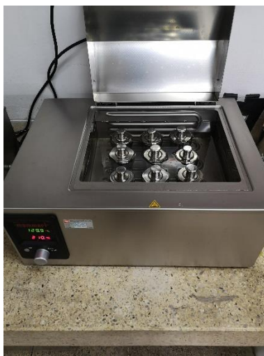
รูปที่ 3.2 การสังเคราะห์แมงกานีสไดออกไซด์ด้วยกระบวนการไฮโดรเทอร์มัลและการให้ความร้อนในอ่างน้ำมัน
