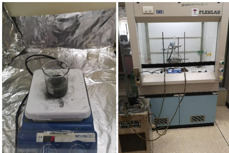
รูปที่ 3.1 กระบวนการชะละลายด้วยกรดและการชะละลายด้วยกรดที่อุณหภูมิสูง
