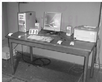
รูปที่ 2.3 การจัดวางผลิตภัณฑ์เพื่อทำการทดสอบการแพร่รบกวนผ่านสายตัวนำ
