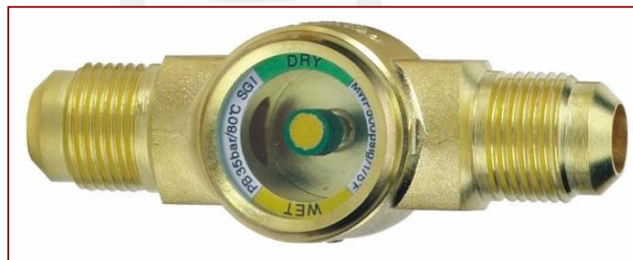
รูปที่ 4.10 สภาพของ Sight glasses กระจกด้านหน้าต้องไม่มีรอยแตกร้าว ใสสามารถมองเห็นสารทำความเย็นได้อย่างชัดเจน
