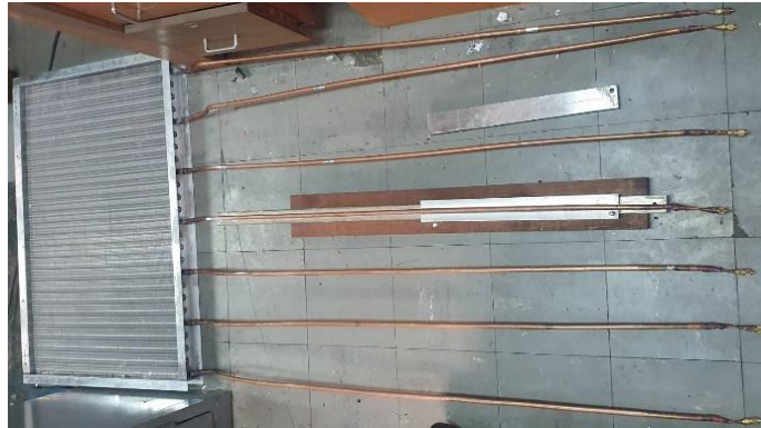
รูปที่ 23 การใช้แม่พิมพ์กดอัดท่อฮีทไปป์ทองแดง 3 หุน บริเวณส่วนระเหย
