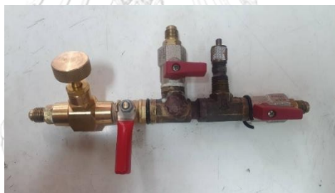
รูปที่ 17 แสดงวาล์วรูปตัวที ใช้สำหรับทำสุญญากาศและเติมของเหลวทำงานเข้าท่อฮีทไปป์
