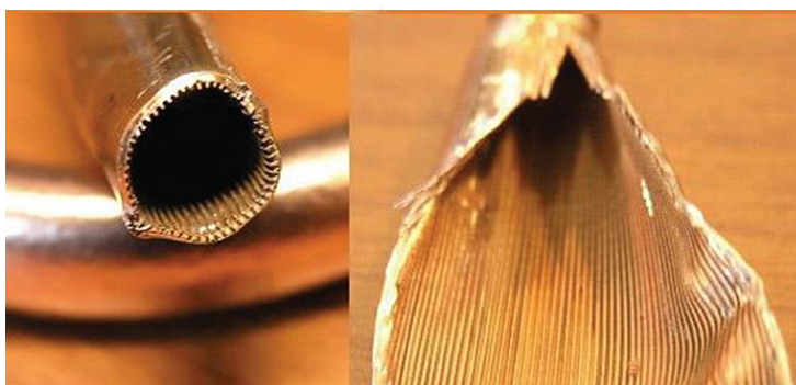
รูปที่ 8 ภาพแสดงwick (wick) แบบร่อง (Grooved wick) ภายในท่อทองแดง
