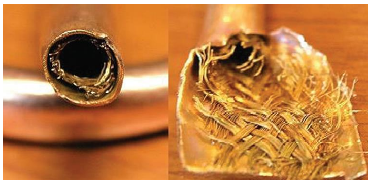
รูปที่ 9 ภาพแสดงwick(wick) แบบตาข่าย (mesh wick) ภายในท่อทองแดง
