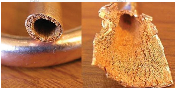
รูปที่ 10 ภาพแสดงwick(wick) แบบผงอัด (Sintered powder wick) ภายในท่อทองแดง
