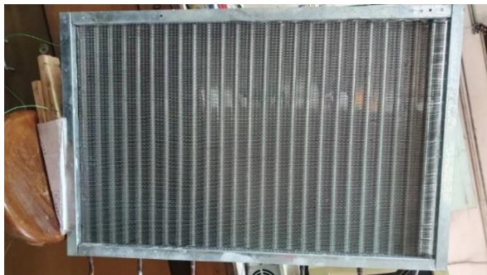
รูปที่ 16 แผงระบายความร้อนส่วนควบแน่นอัดติดกับครีบอลูมิเนียมกับท่อฮีทไปป์ขนาด 4 หุน จำนวน 7 ท่อ
