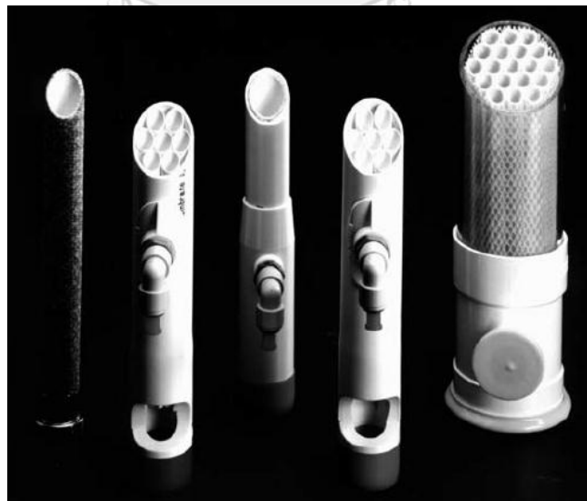
รูปที่ 2.13 ลักษณะโมดูลแบบท่อ (Baker, 2004)
