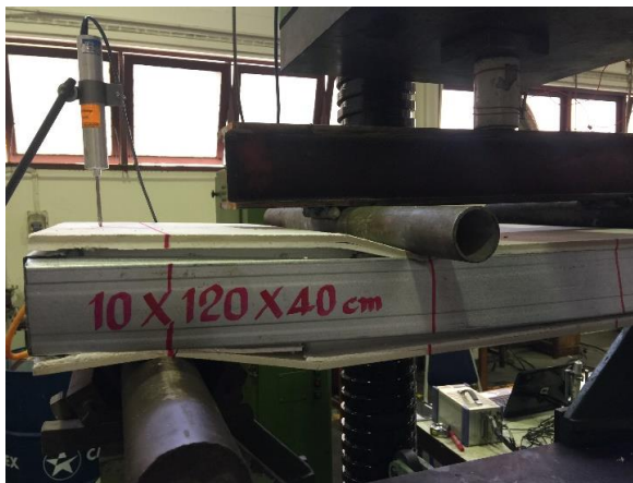
รูป 4-13 การพังของในรูปแบบการรับแรงเฉือนของโฟม
