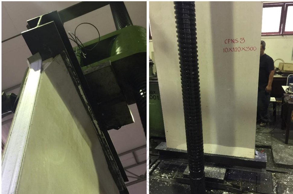
รูป 4-19 การฟุ้งของแผ่นประกอบที่เป็นฉนวนโฟมแบบมีเหล็ก
