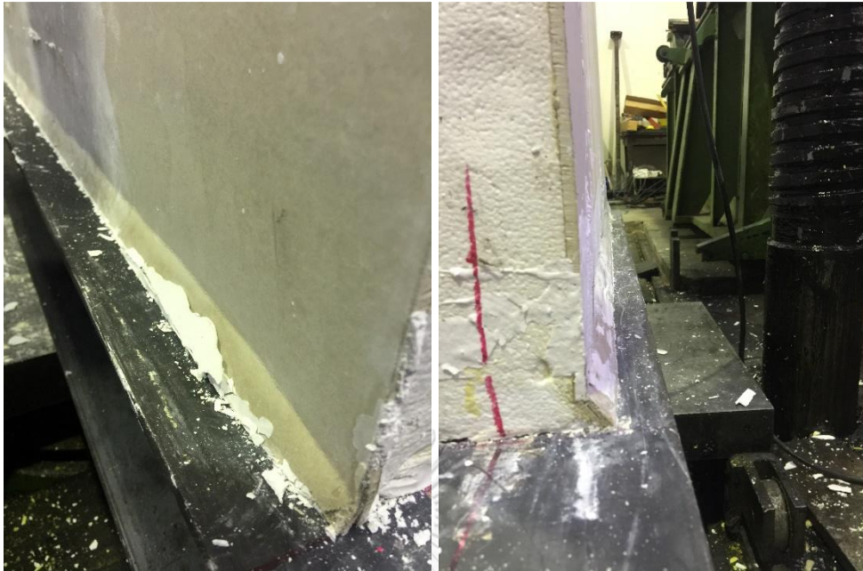
รูป 4-7 การพังของแผ่นประกอบที่เป็นฉนวนโฟมแบบไม่มีเหล็กขนาด 10 ซม.
