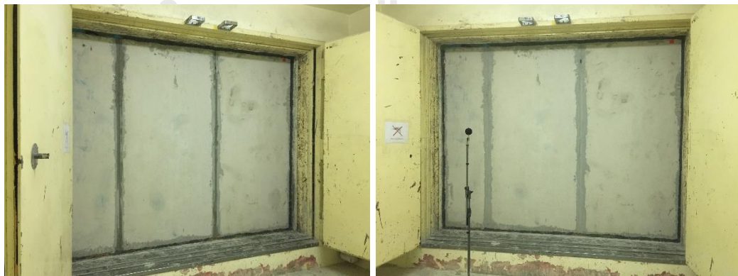
รูป 3-26 ขั้นตอนการเตรียมแผ่นประกอบที่เป็นฉนวนโฟมก่อนการทดสอบการส่งผ่านของเสียง
