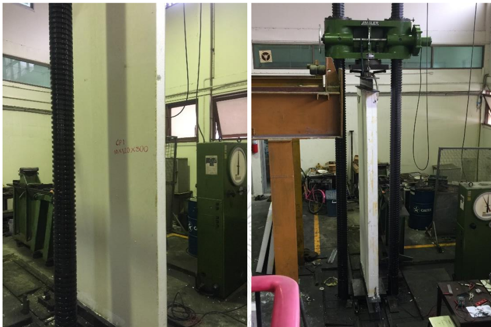
รูป 4-5 การทดสอบแผ่นประกอบที่เป็นฉนวนโฟมแบบไม่มีเหล็กขนาดความหนา 10 ซม. และ 15 ซม.
