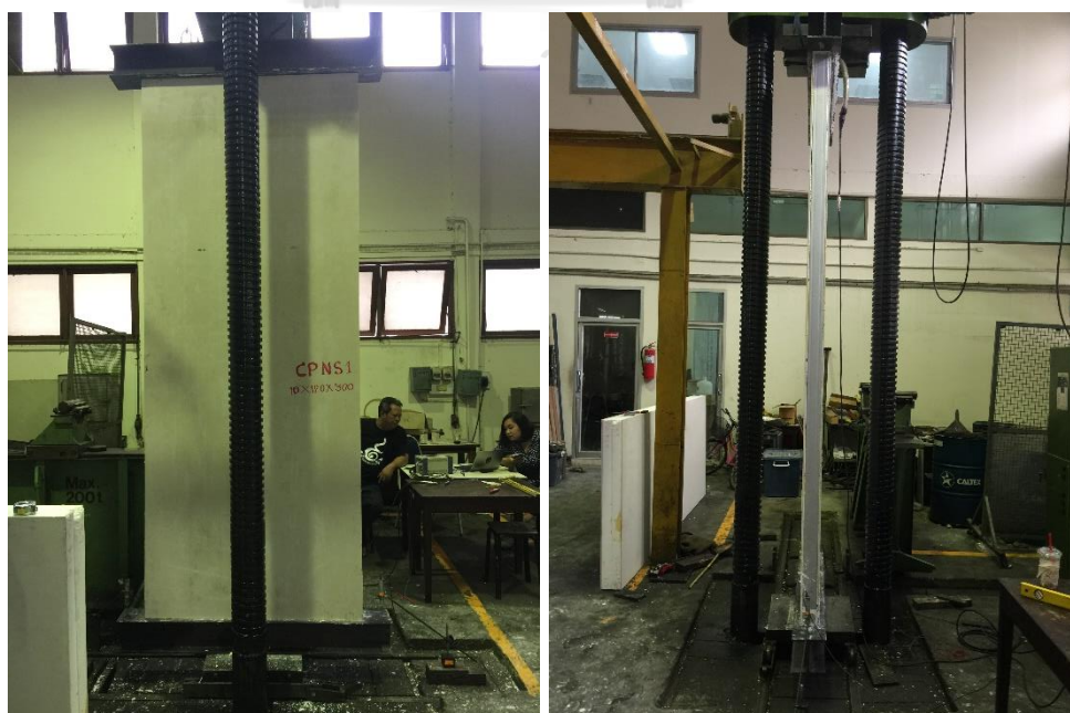
รูป 4-17 การทดสอบแผ่นประกอบที่เป็นฉนวนโฟมแบบมีเหล็ก
