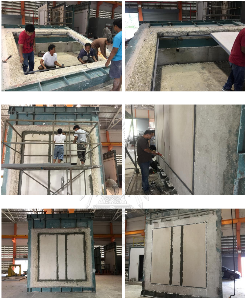
รูป 3-19 ขั้นตอนการเตรียมแผ่นประกอบที่เป็นฉนวนโฟมก่อนการทดสอบทนไฟ
