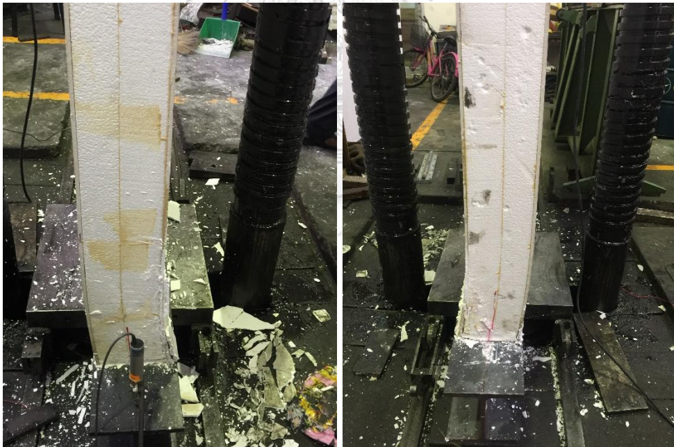
รูป 4-8 การพังของแผ่นประกอบที่เป็นฉนวนโฟมแบบไม่มีเหล็กขนาด 15 ซม.
