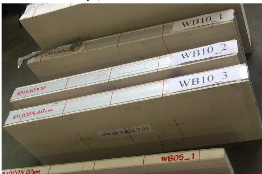
รูป 3-2 แผ่นประกอบที่เป็นฉนวนโฟมแบบมีเหล็กที่นำมาใช้ทดสอบ
