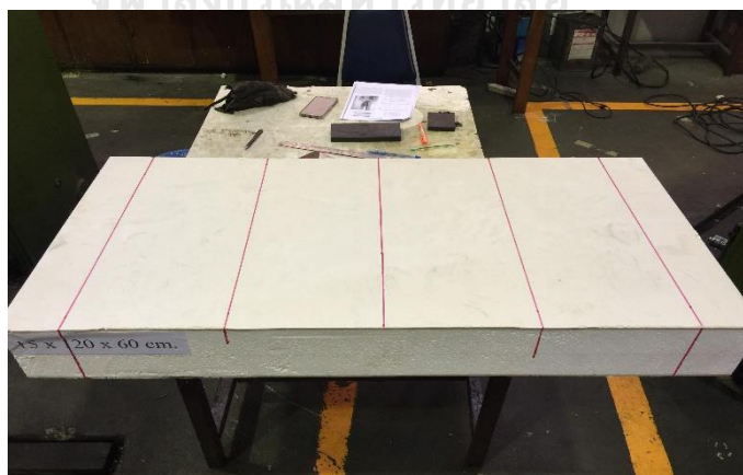
รูป 3-1 แผ่นประกอบที่เป็นฉนวนโฟมแบบไม่มีเหล็กที่นำมาใช้ทดสอบ
