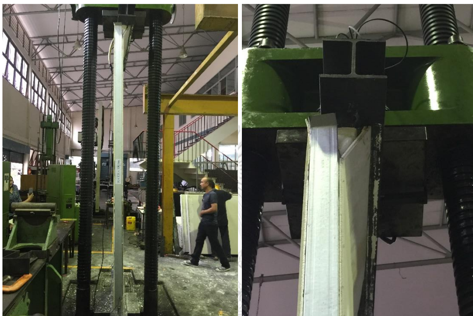
รูป 4-18 การพังของแผ่นประกอบที่เป็นฉนวนโฟมแบบมีเหล็ก
