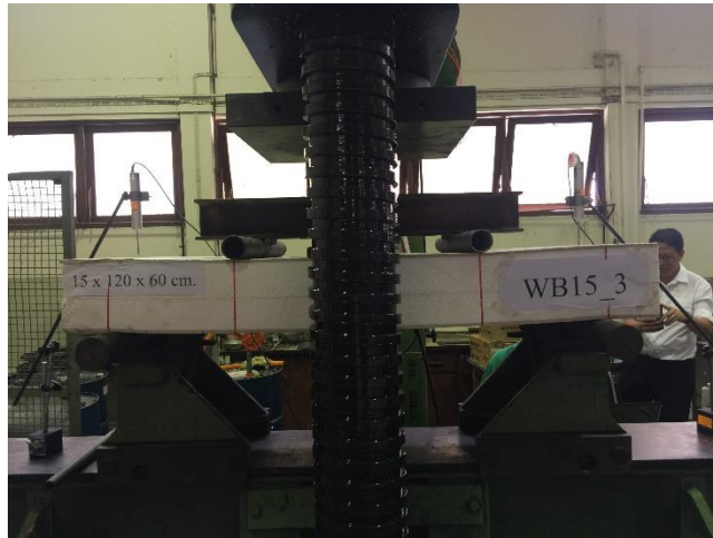
รูป 4-1 การทดสอบแผ่นประกอบที่เป็นฉนวนโฟมแบบไม่มีเหล็ก
