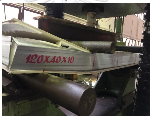
รูป 4-14 การพังของเหล็กจากการบิดงอเสียรูป
