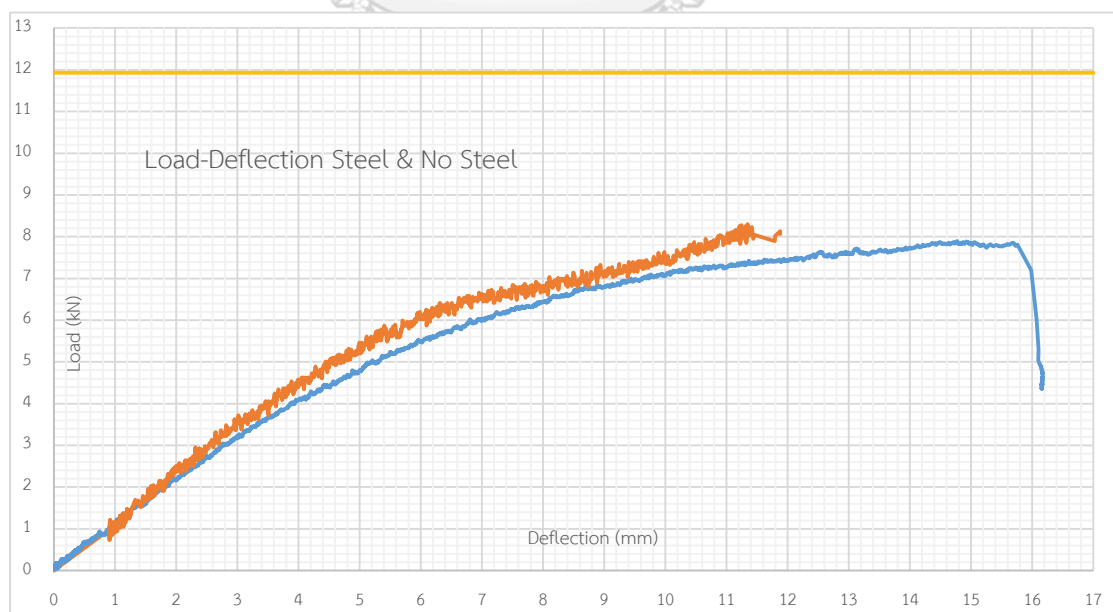
รูป 4-16 กราฟ Load-Deflection ของแผ่นประกอบที่เป็นฉนวนโฟมแบบมีเหล็กและไม่มีเหล็ก
