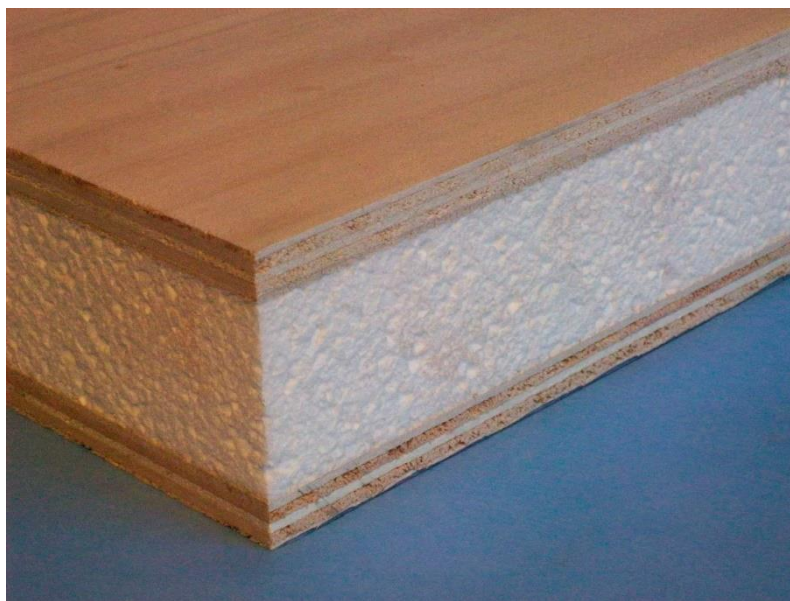
รูป 2-11 แผ่นประกอบที่วัสดุผิวหน้าเป็นไม้อัดและวัสดุแกนกลางเป็นโฟม
