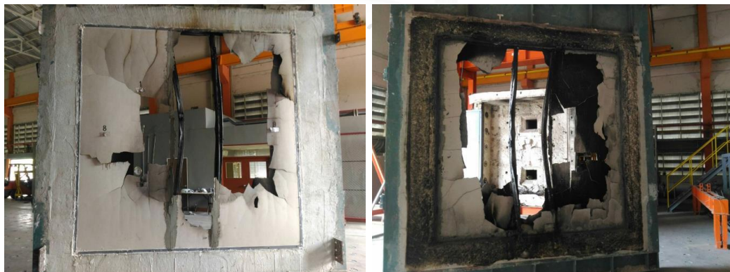
รูป 4-27 ด้านที่ไม่โดนไฟหลังการทดสอบ (ซ้าย) ด้านที่โดนไฟหลังการทดสอบ (ขวา)
