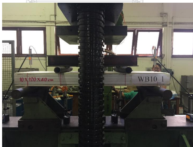
รูป 4-12 การทดสอบแผ่นประกอบที่เป็นฉนวนโฟมแบบมีเหล็ก
