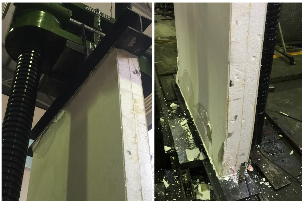
รูป 4-6 การพังแบบ general buckling ของแผ่นประกอบที่เป็นฉนวนโฟมแบบไม่มีเหล็ก หลังจากการทดสอบทำให้ทราบค่าแรงกดสูงสุดที่แผ่นประกอบที่เป็นฉนวนโฟมแบบไม่มี เหล็กขนาด 10 และ 15 ซม.รับได้ และนำค่าที่ได้มาคำนวณหากำลังรับแรงอัด ดังแสดงในตาราง 4-5, ตาราง 4-6
