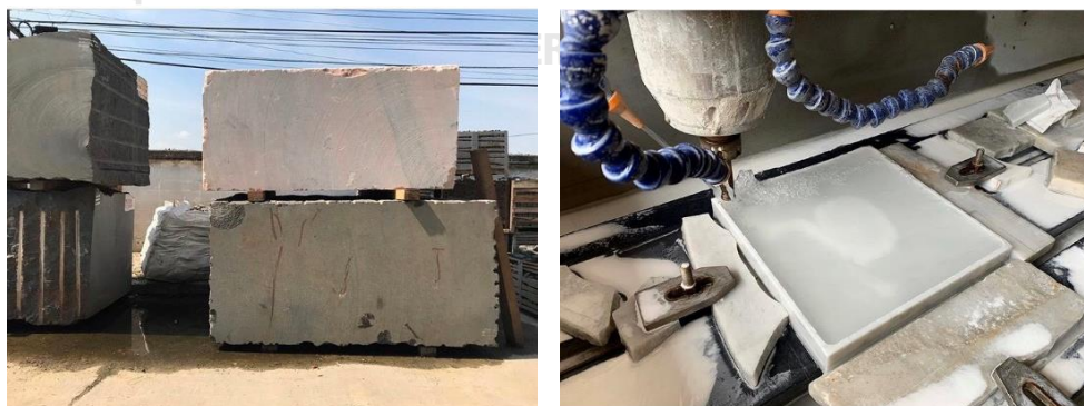
รูปที่ 1.3 ภาพตัวอย่างหินก้อนใหญ่ของโรงงานผลิตและภาพเครื่อง CNC ขณะทำการผลิต (ที่มา Instagram ของบริษัทกรณศึกษา, 2563)
