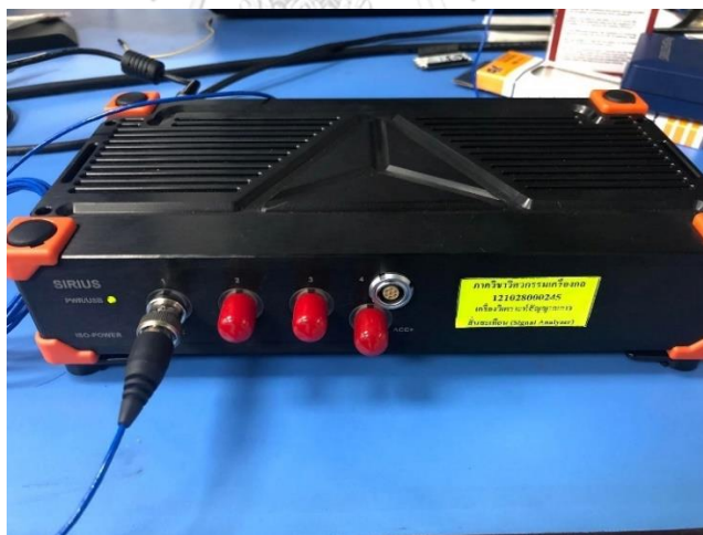
รูปที่ ก.12 Data Acquisition รุ่น Dewesoft Sirius
