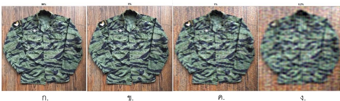
รูปที่ 2.7 สัญญาณภาพที่ถูกสร้างขึ้นตามขนาดข้อมูลความถี่จากรูปที่ 2.6 ก.) 99% ข.) 5% ค.) 1% ง.) 0.2%
